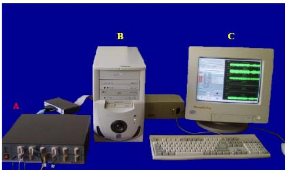
Figura 1. Eletromiógrafo Myosystem I<sup>®</sup> da *Prossecon Ltda.* de 12 canais, sendo 8 canais para eletromiografia e 4 canais de apoio (A). Microcomputador com placa de conversor A/D instalada (B). Monitor mostrando a aquisição do sinal eletromiográfico por meio do software *Myosystem I* versão 2.12 (C). Laboratório de Eletromiografia da FOP/UNICAMP
