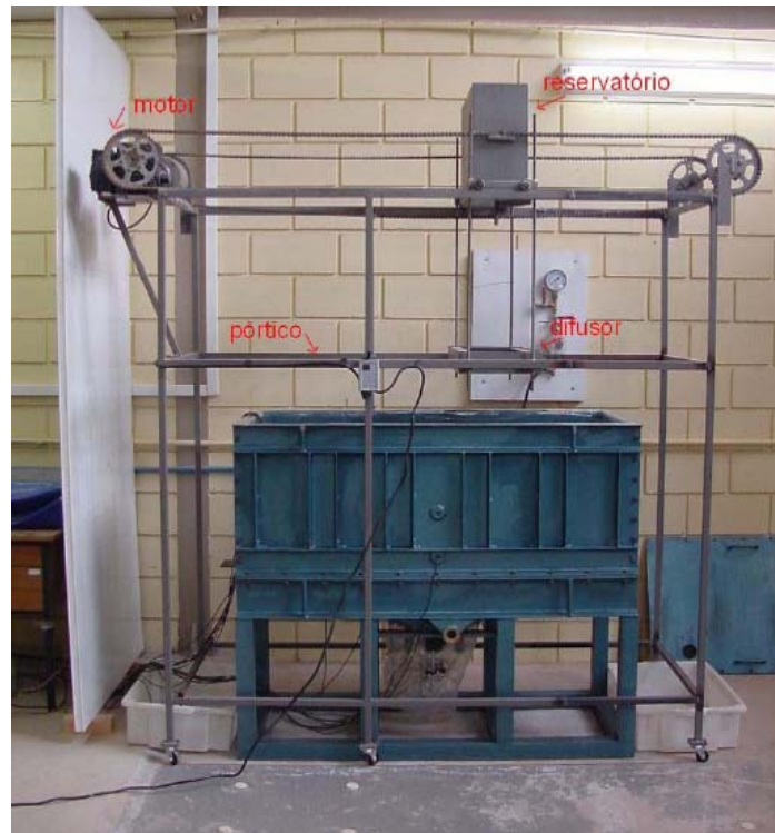
Figura 3.3. Vista Geral do equipamento da chuva de areia (COSTA, 2005).
