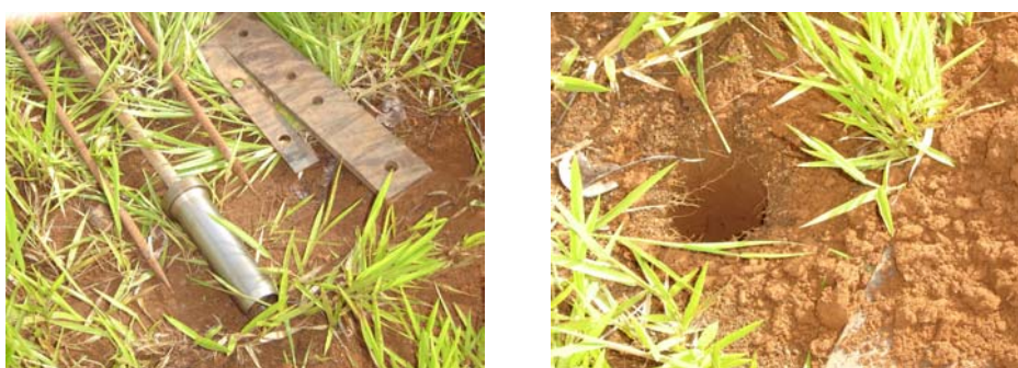
Figura 4.5 – Amostrador de parede fina tipo shelby (adaptado)
