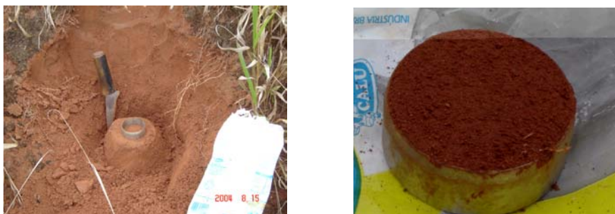
Figura 4.8 – Amostra indeformada extraída com o uso de anel volumétrico.
