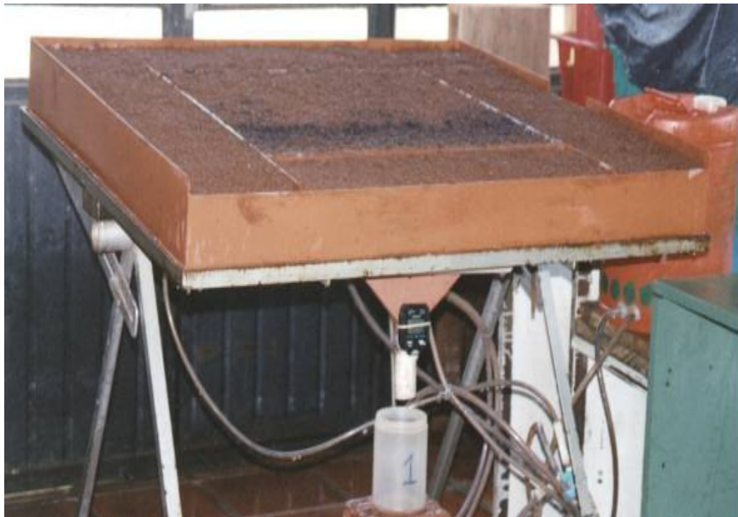
Figura 2.1. Parcela experimental e sistema de umedecimento e drenagem.
