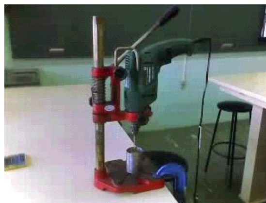
Foto 1.4 - Representa a furadeira com o cilindro para a realização dos furos.
