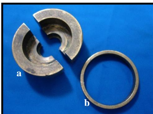
Figura 3 - Suporte cilíndrico metálico bi-partido(a) e arco estabilizador (b).
