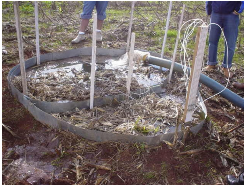
Figura 2 - Detalhe da instalação dos tensiômetros, manômetro e delimitação da área no início do processo de inundação.
