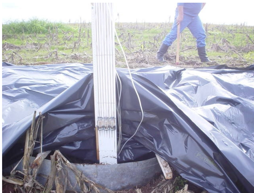
Figura 3 - Detalhe da parcela coberta com lona plástica para evitar evaporação.
