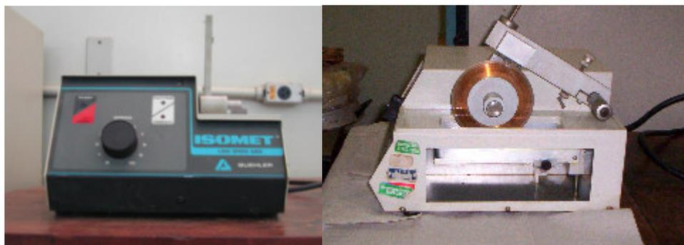
Fig. II.3 - Foto da Máquina para o corte de amostras
