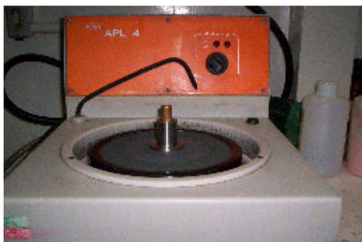
fig. II.4 - Foto: máquina politriz e suporte com amostra
