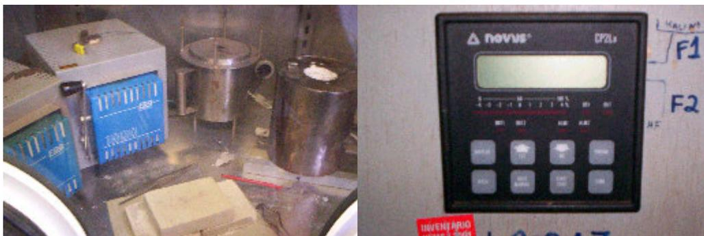
Fig.II.2 Fornos utilizados na preparação de vidro de fluoretos, controlador NOVUS para o forno.
