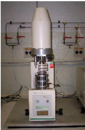
Fig. III.9 – Equipamento Shumadzu 50 para análise TMA
