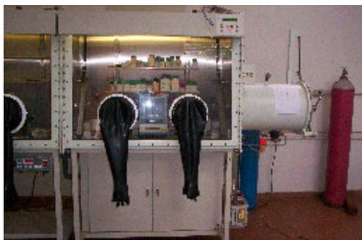
Fig. II.1 – Câmara seca, atmosfera N<sub>2</sub>.
