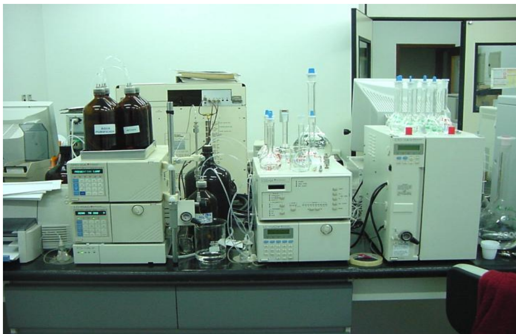
Figura 1. Cromatógrafo Líquido de Alta Eficiência (CLAE) utilizado no desenvolvimento do método analítico de determinação de diuron e hexazinone
