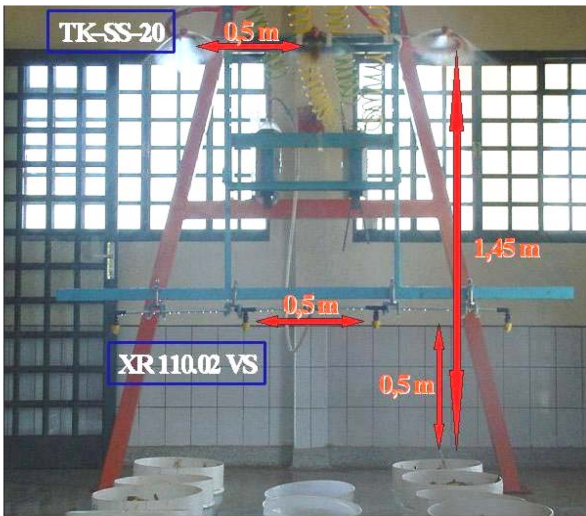
Figura 2. Equipamento de pulverização e simulação de precipitação, instalado no NuPAM.
