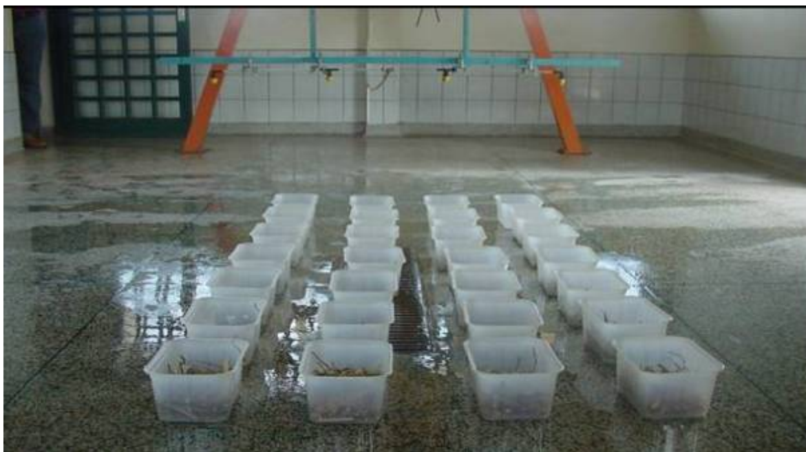
Figura 3. Suportes de plástico com as palhas usadas para estudo de transposição dos produtos no momento da aplicação.
