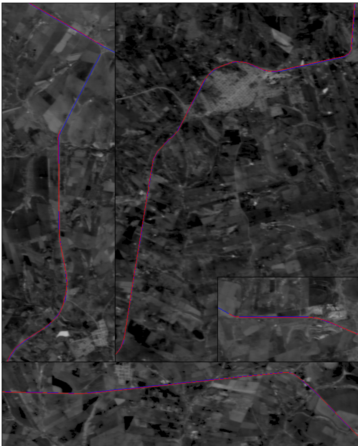
Figura 37 – Experimento 5: rodovias extraídas e as correspondentes projetadas após a convergência do processo de orientação (recorte 2).
