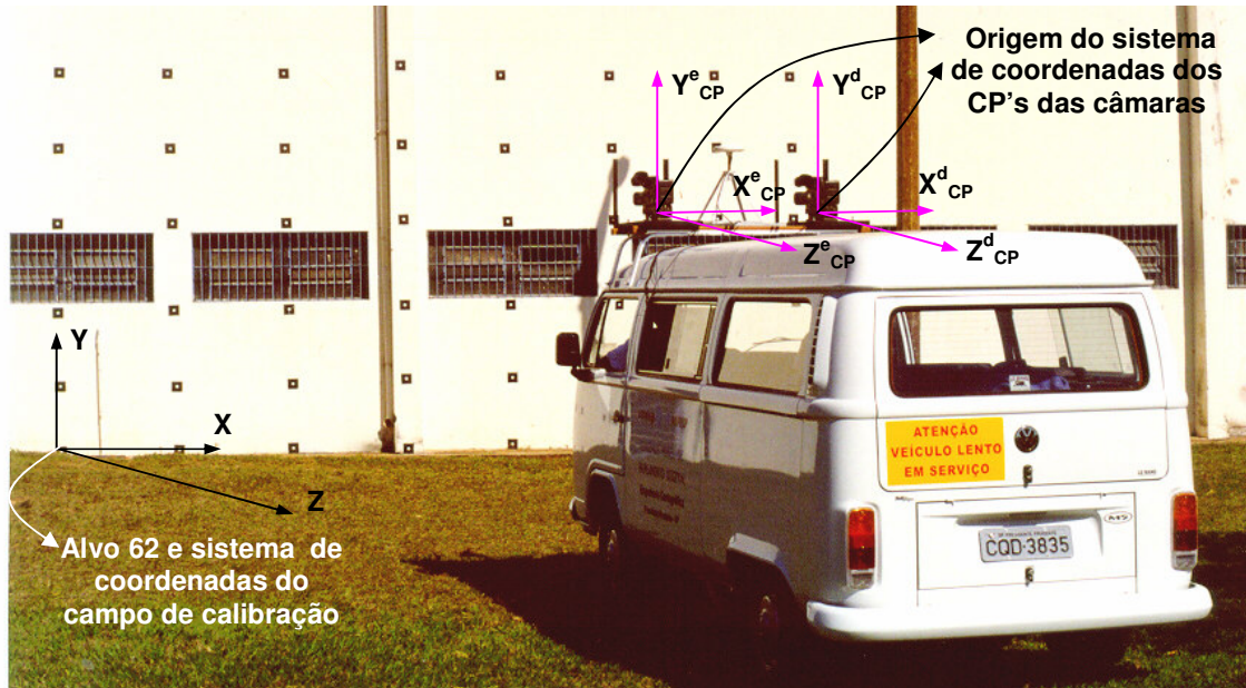
Figura 07 – Sistemas de coordenadas topográficas: local e dos centros perspectivos das câmaras (CP's)
