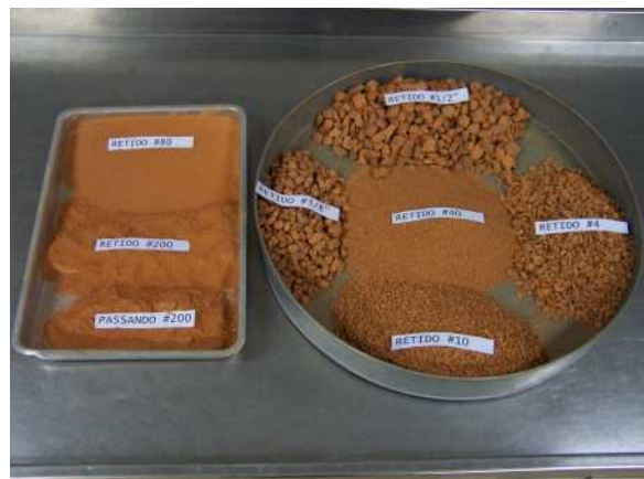
FIG.5.44 Detalhe do beneficiamento dentro das granulometrias a serem empregadas por ocasião da dosagem da mistura asfáltica.
