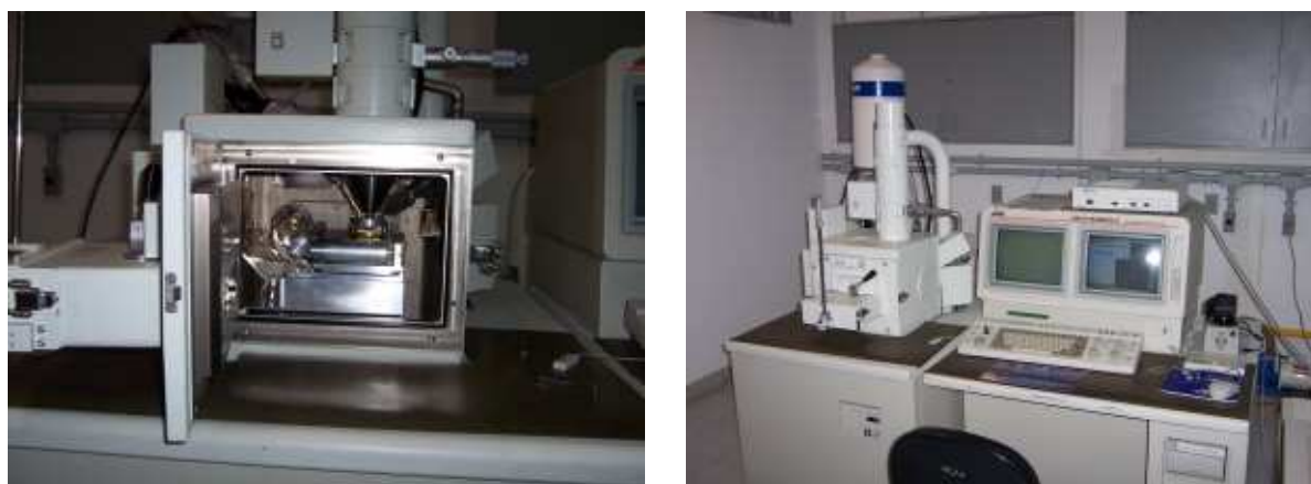
FIG.5.15 Execução do ensaio EDS no equipamento MEV do IME.
