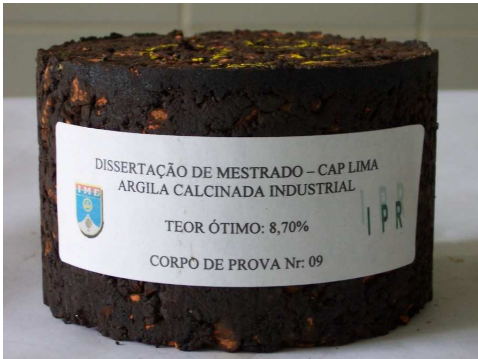
FIG.5.49 Detalhe de um corpo de prova com o teor de ligante pela dosagem Marshall de 8,7%.
