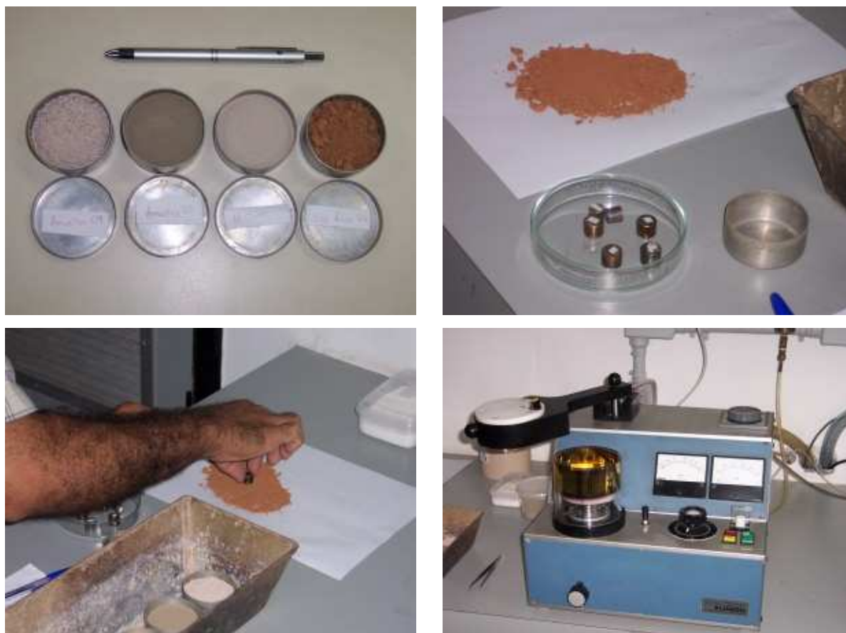
FIG.5.14 Seqüência da preparação das amostras para o ensaio EDS.
