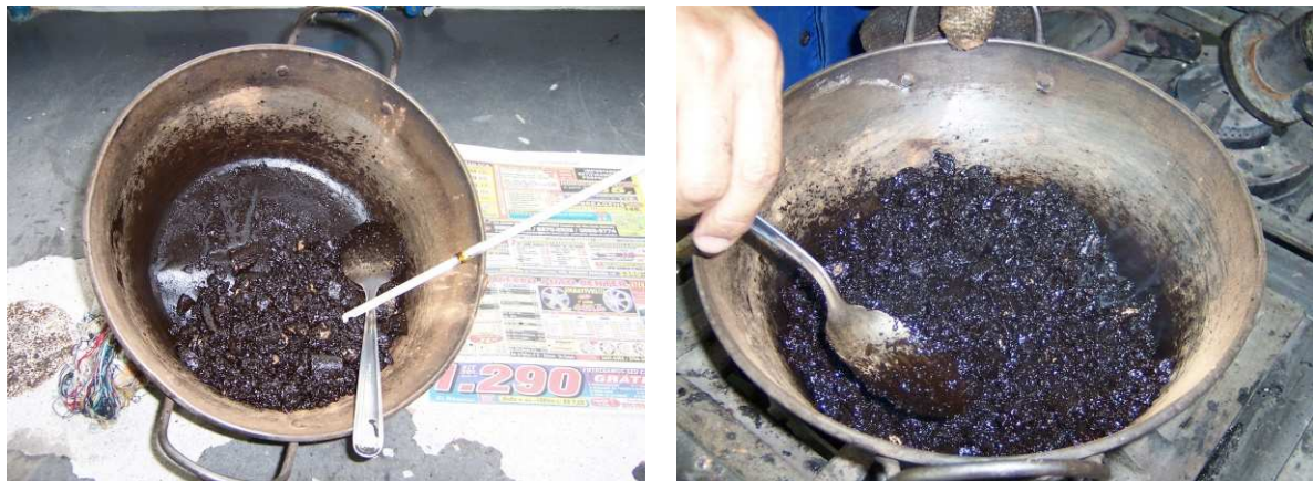
FIG.5.47 Execução da dosagem pelo método Marshall com teor de ligante de 10% (esquerda) e 11% (direita).
