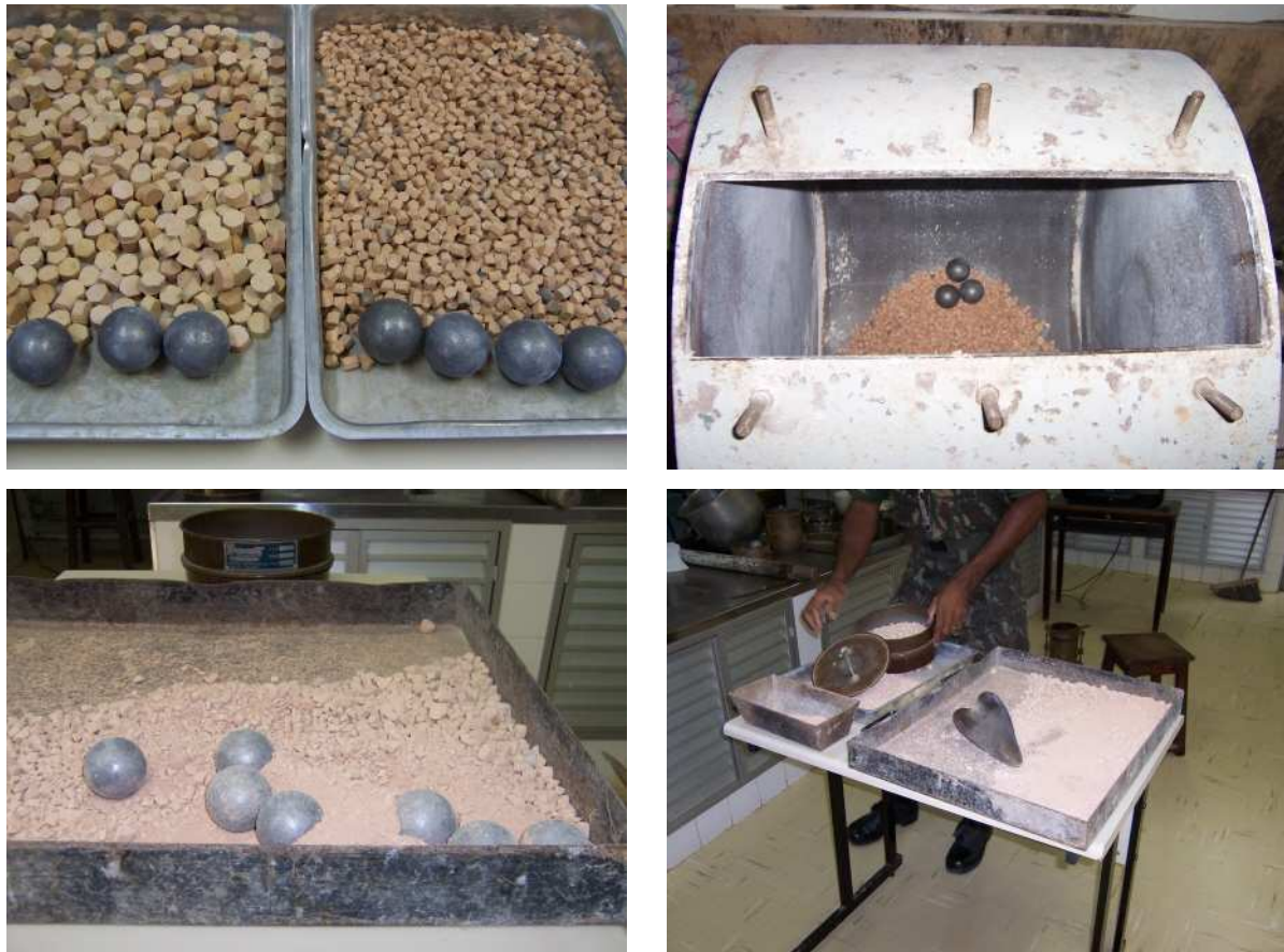
FIG.5.19 Seqüência operacional do ensaio de desgaste por abrasão no aparelho Los Angeles.
