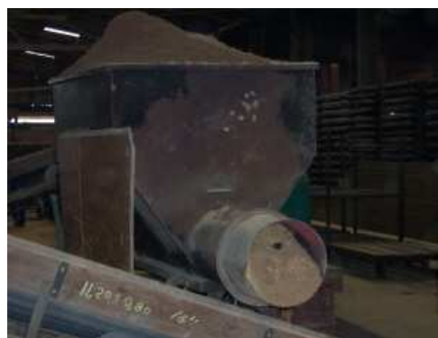
FIG.3.41 Depósito e incorporação de carvão mineral moído à massa argilosa antes da etapa de extrusão (Cerâmica Marajó).
