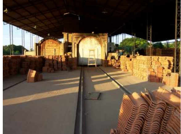
FIG.5.31 Vista geral dos dois fornos tipo túnel e do sistema de trilhos para o deslocamento dos vagões.
