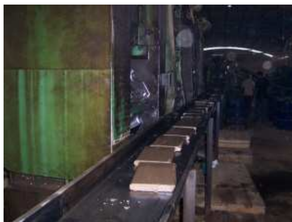
FIG.3.42 Extrusão e corte dos tijolos; extrusão e prensagem de telhas (Cerâmica Marajó).
