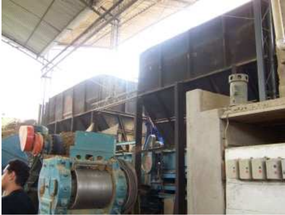
FIG.3.35 Detalhe dos silos dosadores de argila e do equipamento triturador na seqüência (Cerâmica São Silvestre).
