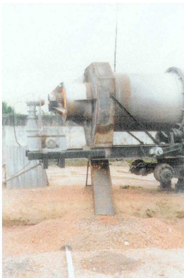
FIG.2.11 Detalhe da saída do forno rotativo em operação, e do conjunto sobre o chassi de uma carreta (Relatório do Convênio MT/UFAM, 2004).
