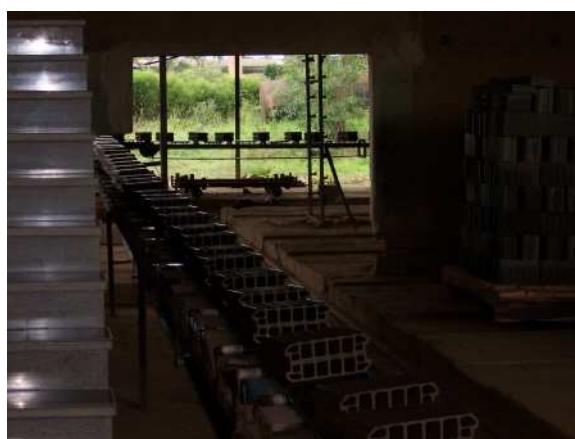
FIG.3.50 Linha de produção automatizada: após extrusão e corte (esquerda) as peças são destinadas para os carros em esteiras rolantes.
