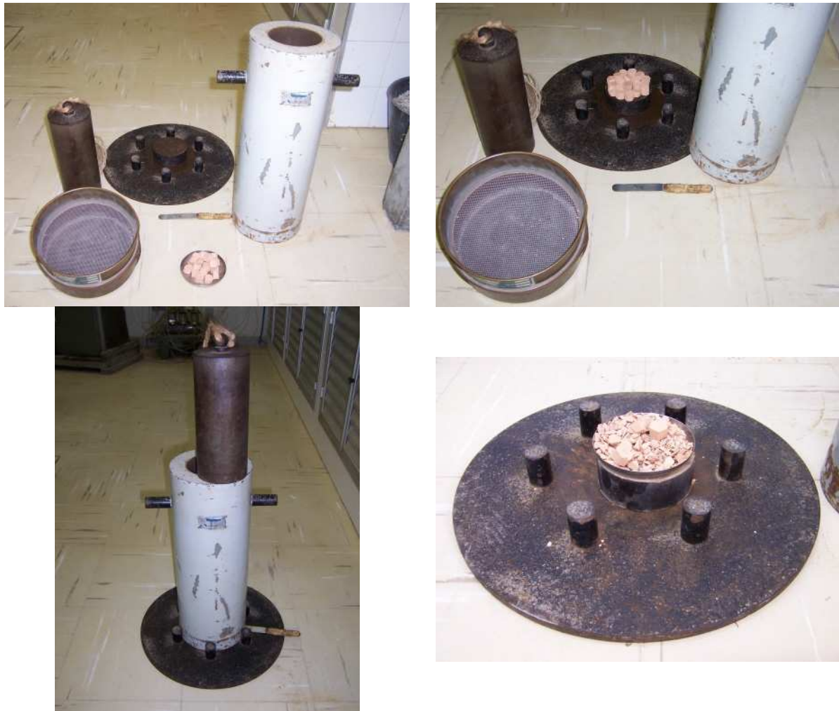
FIG.5.22 Determinação da perda ao choque no aparelho Treton.
