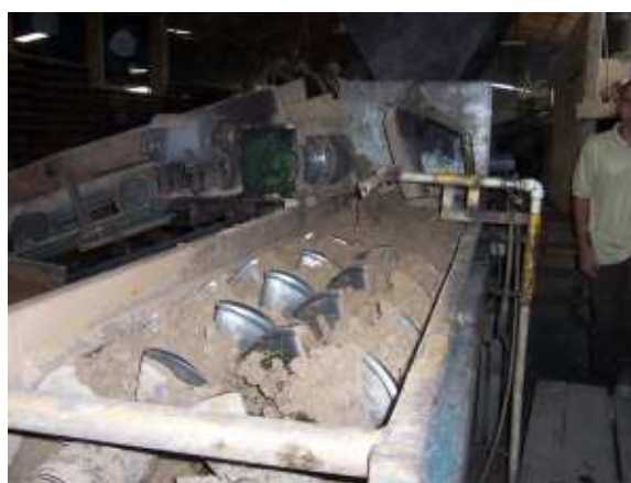
FIG.3.40 Funcionamento de equipamento misturador com dois eixos de hélices helicoidais (Cerâmica Marajó).
