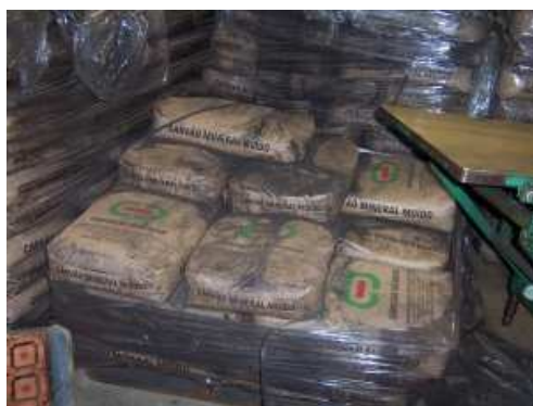
FIG.3.41 Depósito e incorporação de carvão mineral moído à massa argilosa antes da etapa de extrusão (Cerâmica Marajó).
