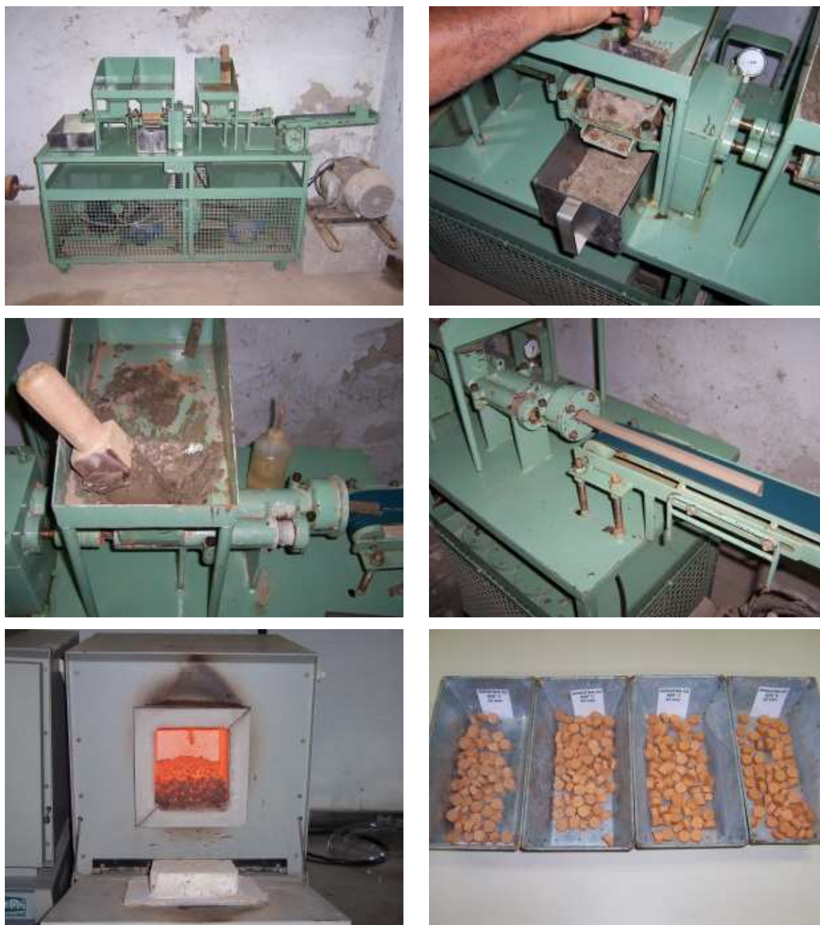
FIG.5.18 Seqüência para produção dos corpos de prova: máquina extrusora do IME, laminação, massa plástica, extrusão e moldagem, queima, corpos de prova.
