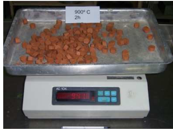
FIG.5.27 Execução do ensaio de absorção e densidade aparente do agregado de argila calcinada.
