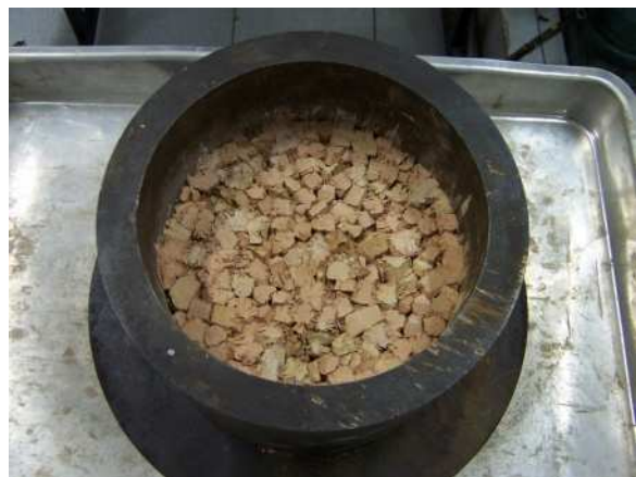
FIG.5.21 Avaliação da resistência mecânica (10% de finos e resistência ao esmagamento).
