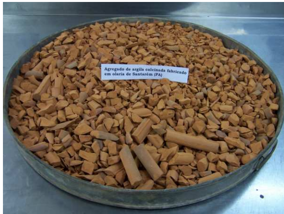
FIG.5.42 Forma do agregado original proveniente de Santarém. Nota-se a presença ainda de algumas peças cilíndricas e de superfícies externas arredondadas.
