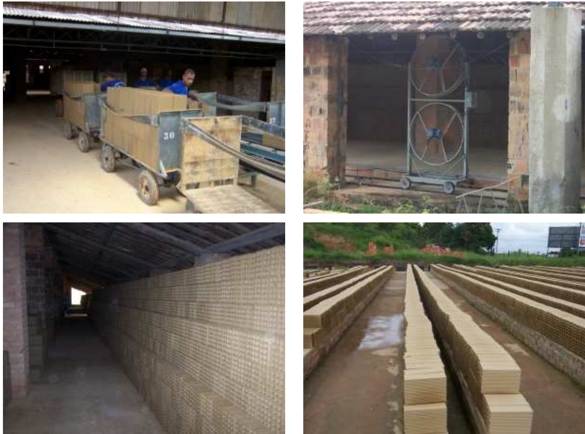
FIG.3.37 Seqüência das etapas da secagem: transporte; exaustores para secagem; 1ª secagem em galpão; 2ª secagem ao ar (Cerâmica São Silvestre).
