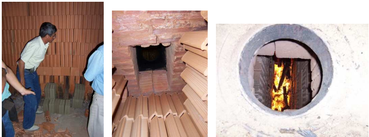
FIG.3.47 Funcionamento do forno Hoffmann: detalhes do empilhamento (esquerda); abertura entre as peças para entrada da lenha e vista de cima da queima.
