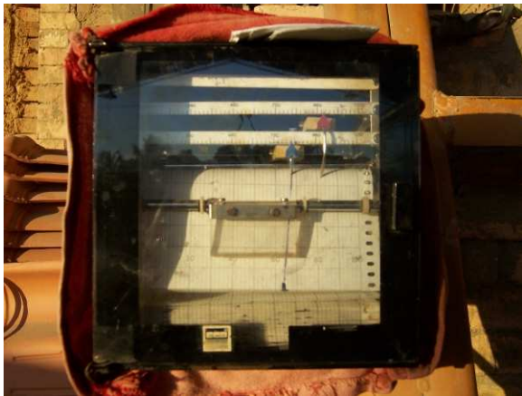
FIG.5.32 Dispositivo de controle da temperatura embutido na parede do forno túnel.
