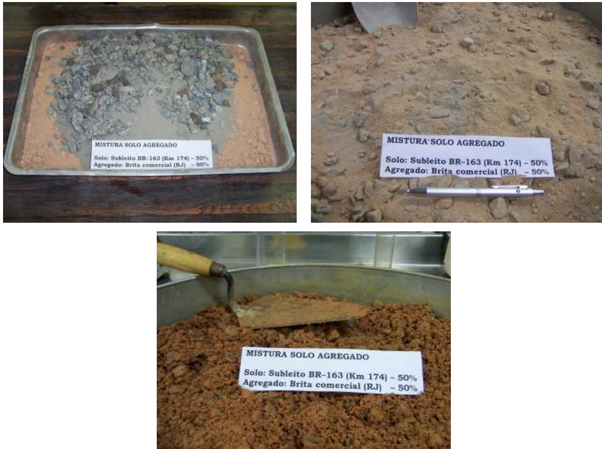
FIG.5.38 Mistura solo-agregado com brita comercial do RJ – detalhe da preparação, homogeneização e a mistura na umidade ótima.
