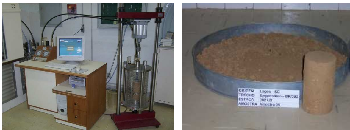
FIG.5.41 Equipamento triaxial do IME para a realização do ensaio de módulo de resiliência. Detalhe de um CP após o ensaio.
