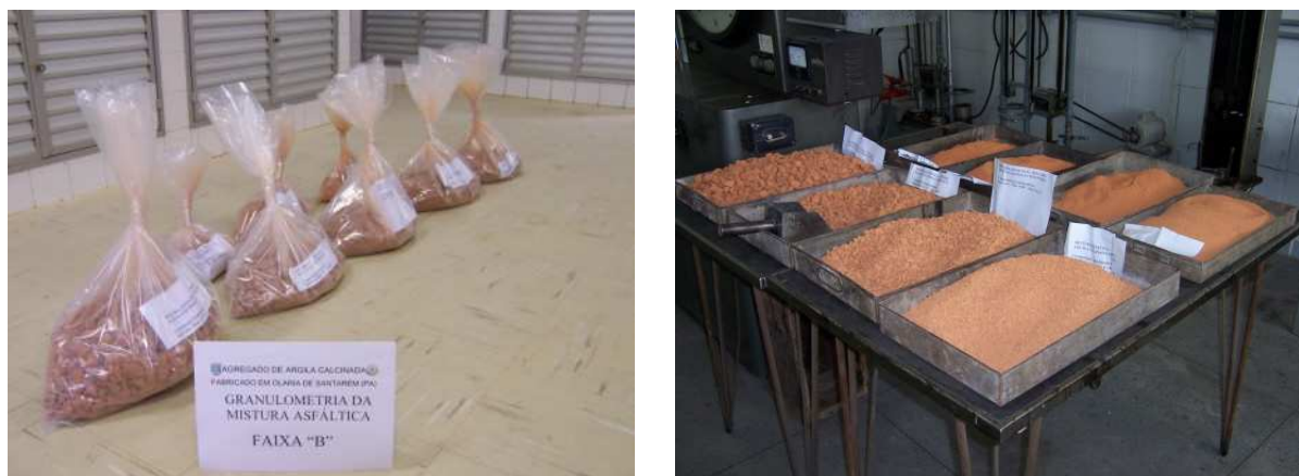
FIG.5.45 35 Kg de agregados de argila calcinada industrial separados por peneiras para atender a curva de projeto (à esquerda no IME, e à direita no IPR/DNIT).
