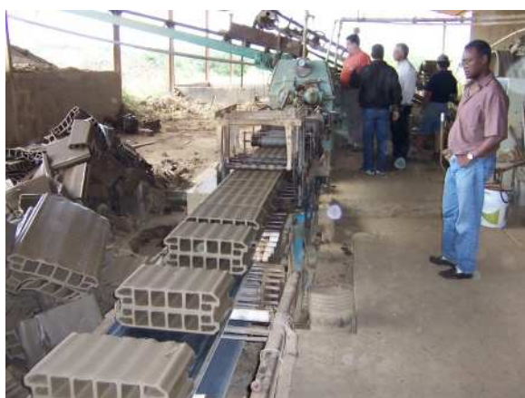
FIG.3.50 Linha de produção automatizada: após extrusão e corte (esquerda) as peças são destinadas para os carros em esteiras rolantes.
