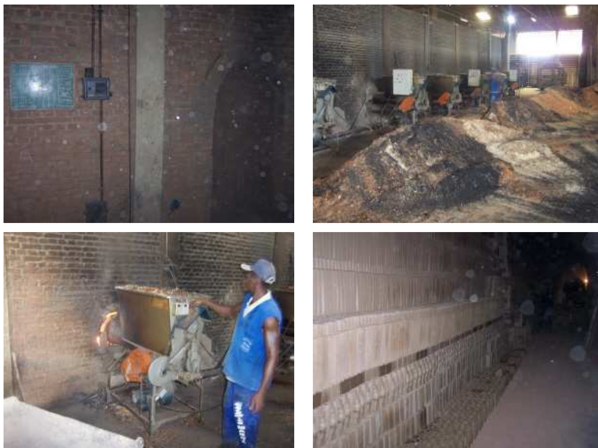
FIG.3.44 Etapa de queima: controle da temperatura; mistura de serragem e carvão utilizado como combustível; carros com termômetro e maçaricos móveis; empilhamento das peças (Cerâmica Marajó).
