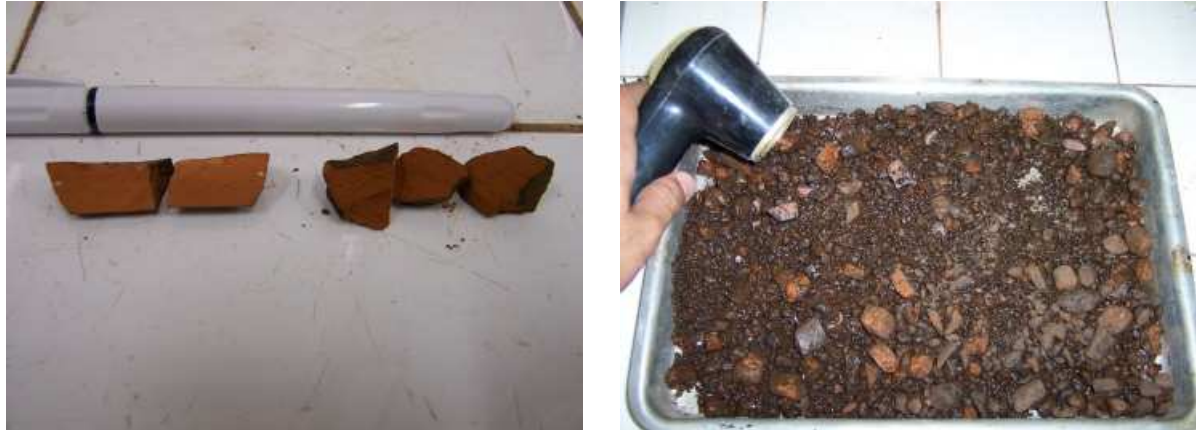
FIG.5.52 Ensaio Rice: Procedimento adicional para agregados porosos.
