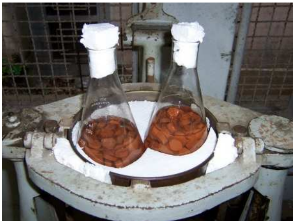
FIG.5.20 Ensaio da perda de massa por desgaste após fervura.
