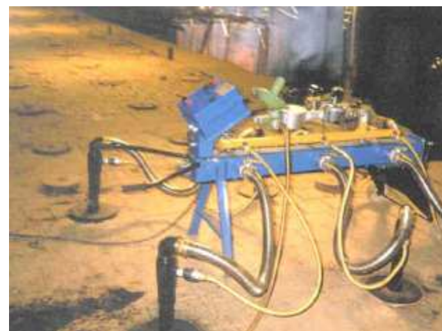
FIG.3.29 Adaptação na alimentação de combustível em forno intermitente (esquerda) e Hoffmann (direita) com queimadores móveis de GN (NERI, 2003).
