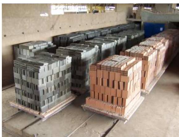
FIG.3.49 Forno túnel: carros destinando as peças para a unidade estufa ou unidade de queima final; peças após queima (direita).
