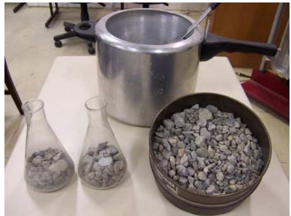
FIG.5.20 Ensaio da perda de massa por desgaste após fervura.
