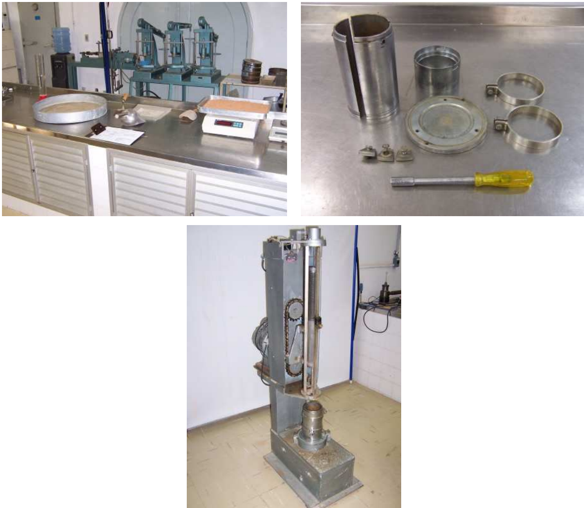
FIG.5.40 Preparação para ensaio de módulo: Mistura na umidade ótima; molde tripartido para conformação do corpo-de-prova (CP) de 10cm x 20cm; compactador elétrico do CP.
