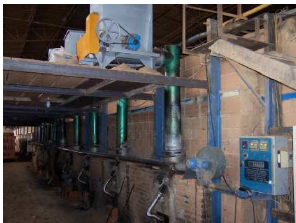
FIG.3.48 Forno túnel: queimadores para serragem e/ou gás natural; unidade de pré-tratamento da serragem (direita).
