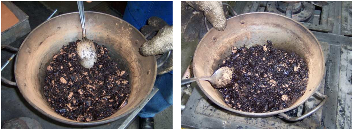
FIG.5.46 Execução da dosagem pelo método Marshall com teor de ligante de 8% (esq.) e 9% (dir.).
