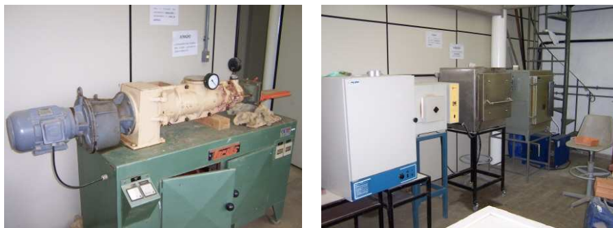
FIG.3.51 Extrusora à vácuo e linha de fornos do laboratório da UENF.
