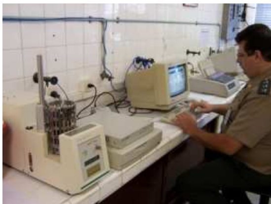
FIG.5.16 Ensaio de análise térmica no IME: pesagem da amostra (acima); conjunto de equipamentos para ATD/ATG (centro); execução do ensaio de ATD (abaixo).
