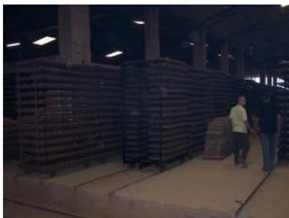
FIG.3.43 Estantes móveis sobre trilhos para secagem inicial das telhas e unidade estufa (Cerâmica Marajó).
