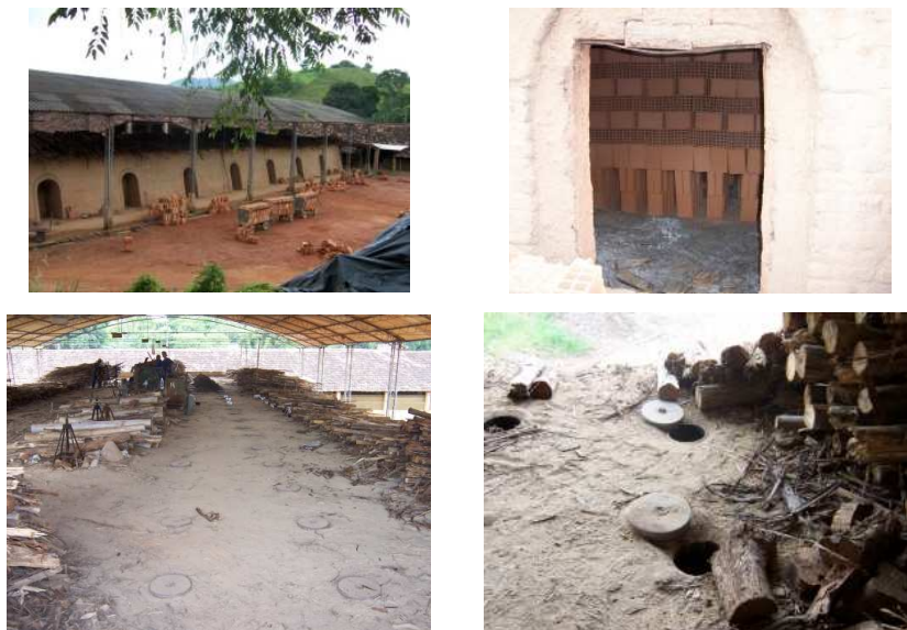
FIG.3.38 Seqüência das etapas de queima: vista geral do forno Hoffmann; detalhe do empilhamento; vistas das escotilhas de topo para entrada de combustível (Cerâmica São Silvestre).
