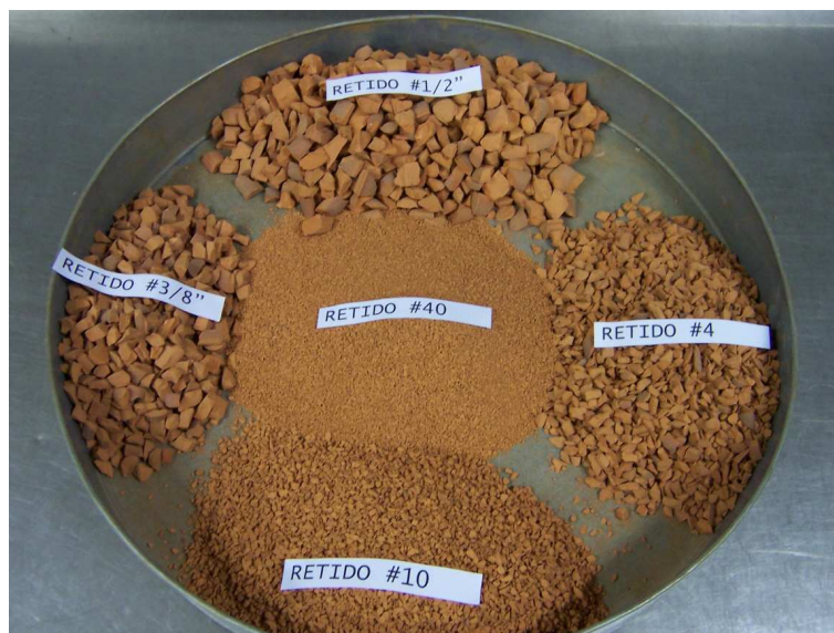
FIG.5.43 Forma do agregado de argila calcinada industrial após o beneficiamento (re-britagem) em laboratório.
