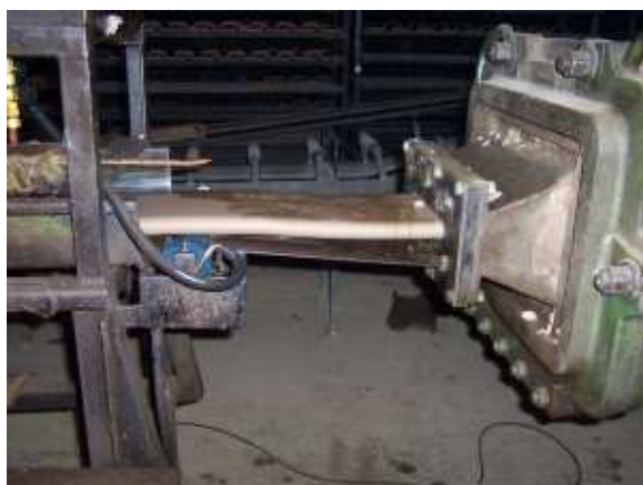
FIG.3.42 Extrusão e corte dos tijolos; extrusão e prensagem de telhas (Cerâmica Marajó).
