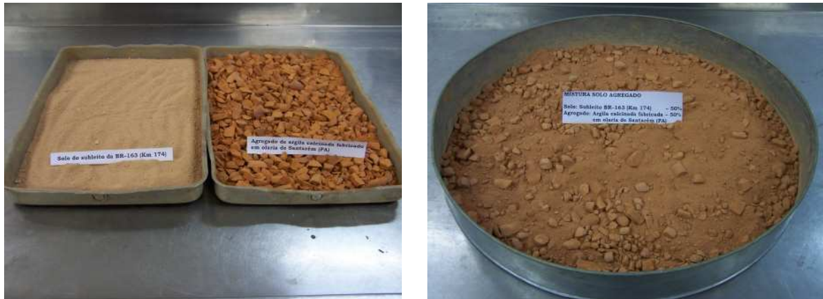
FIG.5.39 Mistura solo-agregado com a argila calcinada industrial: separação e posterior homogeneização das amostras de agregado e de solo do sub-leito da BR-163.
