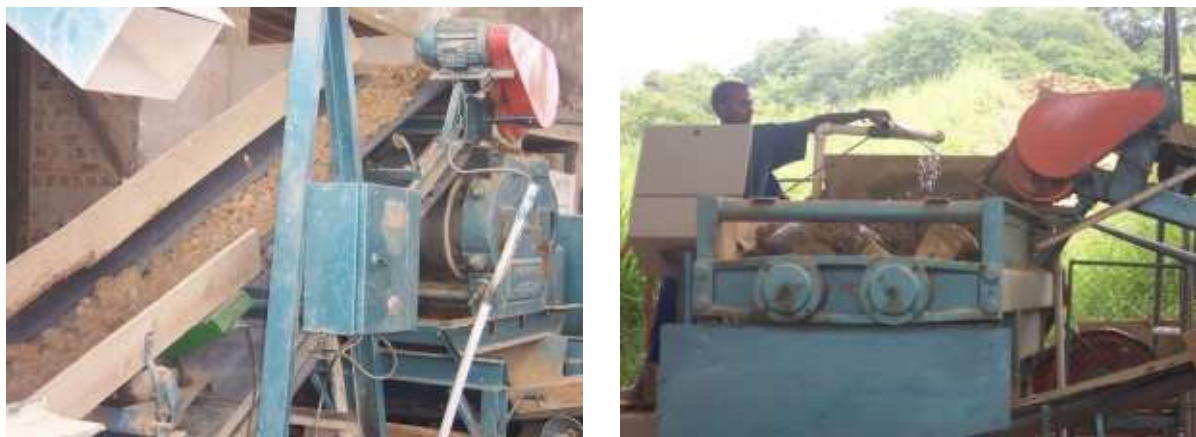
FIG.3.36 Matéria-prima parcialmente homogeneizada seguindo para a umidificação e equipamento misturador (Cerâmica São Silvestre).
