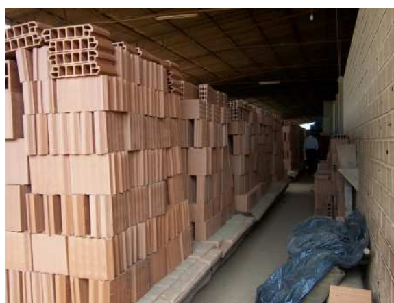
FIG.3.49 Forno túnel: carros destinando as peças para a unidade estufa ou unidade de queima final; peças após queima (direita).
