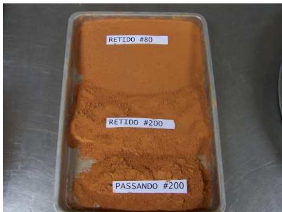
FIG.5.44 Detalhe do beneficiamento dentro das granulometrias a serem empregadas por ocasião da dosagem da mistura asfáltica.
