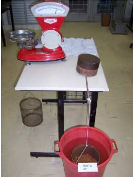
FIG.5.27 Execução do ensaio de absorção e densidade aparente do agregado de argila calcinada.
