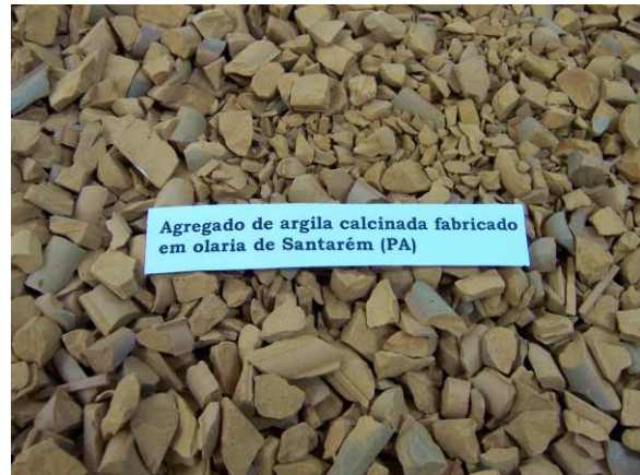
FIG.5.42 Forma do agregado original proveniente de Santarém. Nota-se a presença ainda de algumas peças cilíndricas e de superfícies externas arredondadas.
