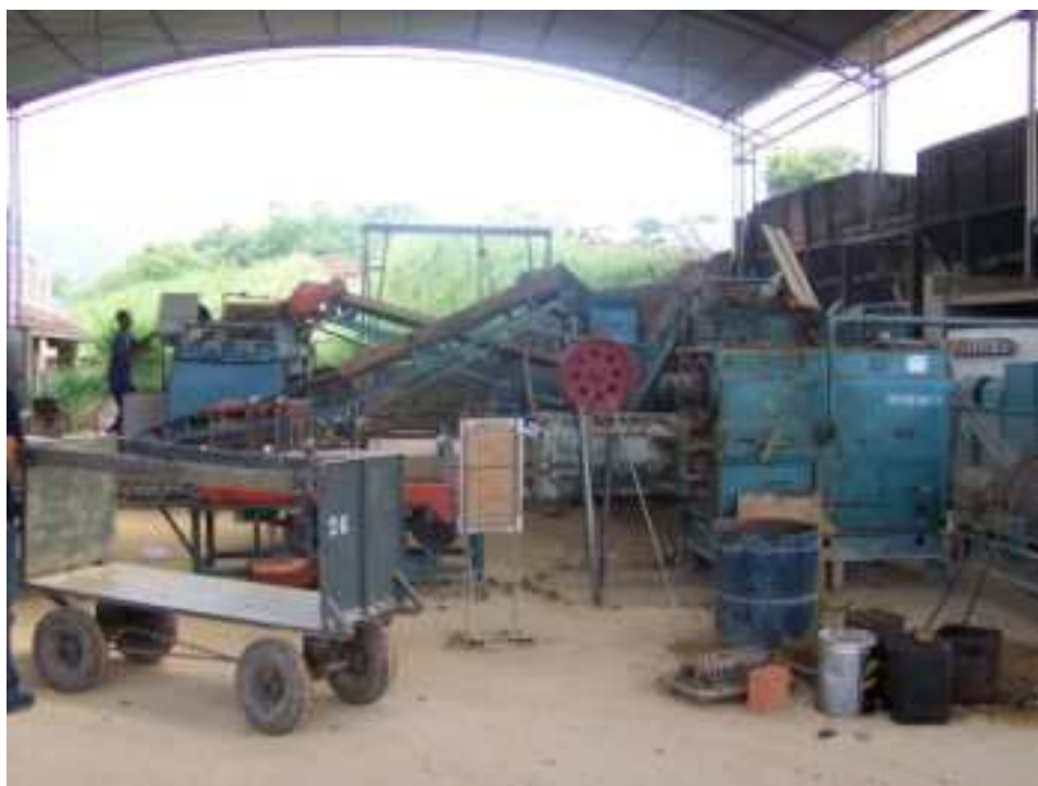
FIG.3.34 Vista interna do galpão com as etapas de preparação e moldagem da matéria-prima (Cerâmica São Silvestre).
