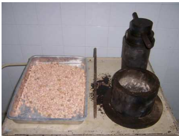
FIG.5.21 Avaliação da resistência mecânica (10% de finos e resistência ao esmagamento).
