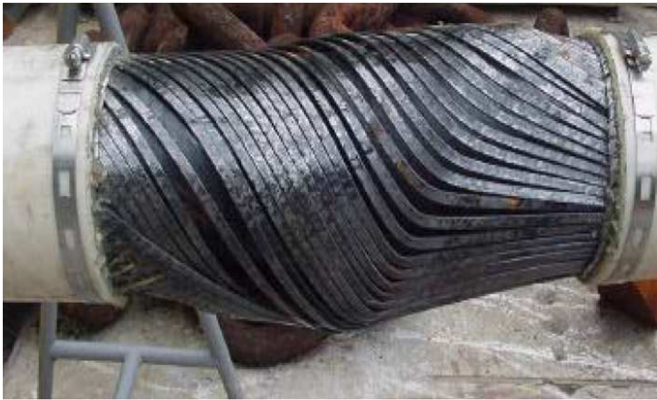
Figura 1.1: Duto flexível em dissecação após falha por instabilidade. Fonte:[3].
