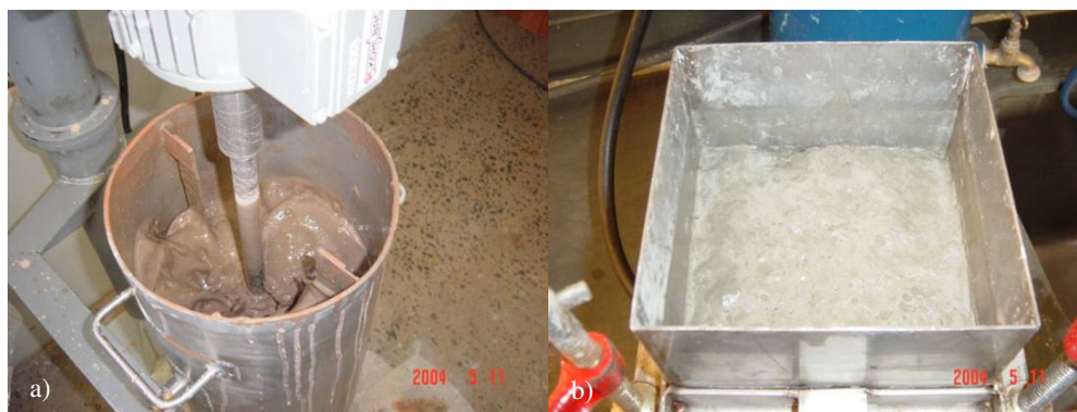
Figura 4.12 a) Mistura das matérias-primas, b) Sucção de água excedente.
