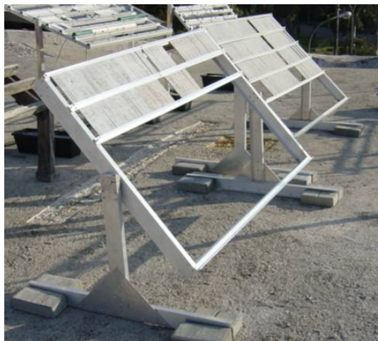
Figura 4.15 Disposição dos corpos-de-prova em rack de alumínio para envelhecimento natural.
