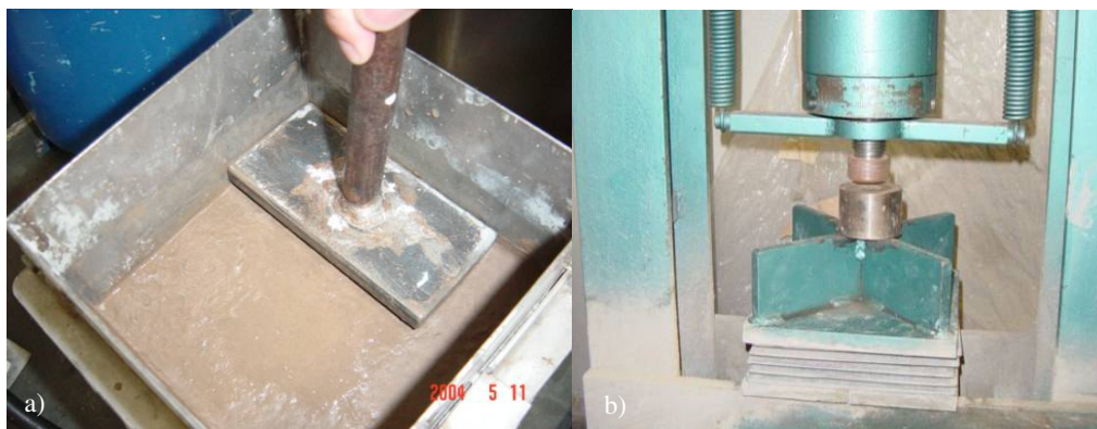
Figura 4.13 a) Uniformização da superfície da pasta com soquete, b) Prensagem das placas.
