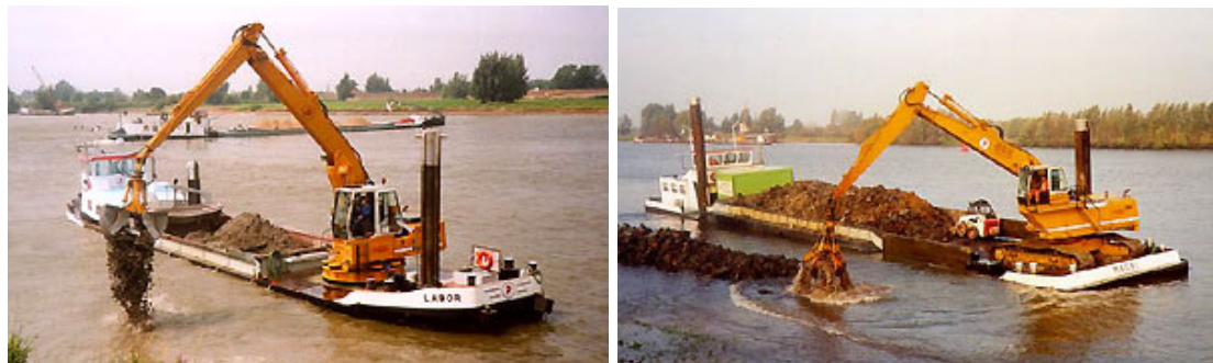
FIG 5.23 - Dragas de Caçamba Labor e Magri, ambas pertencentes à Ballast Ham Dredging
