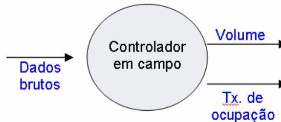
**FIG. 5.6 Estágio 2 – Controlador em campo**
