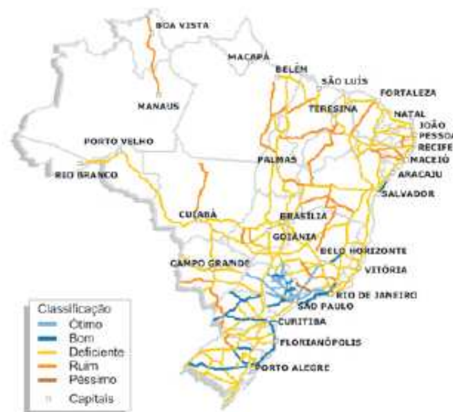
FIG. 2.4 Avaliação Geral das Condições do Pavimento Fonte: CNT 2004
