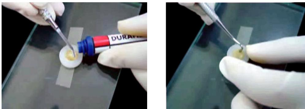
Figura 4.11 – Confeção dos corpos-de-prova com resina composta
