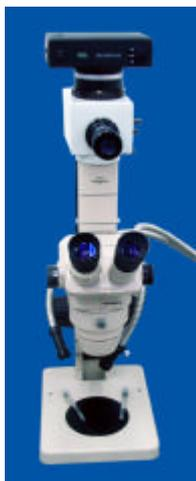
Figura 4.22 – Lupa estereoscópica e máquina fotográfica acoplada
