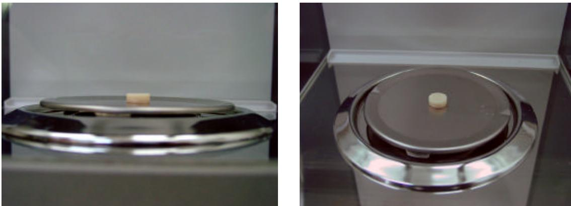
Figura 4.15 – Pesagem dos corpos de prova
