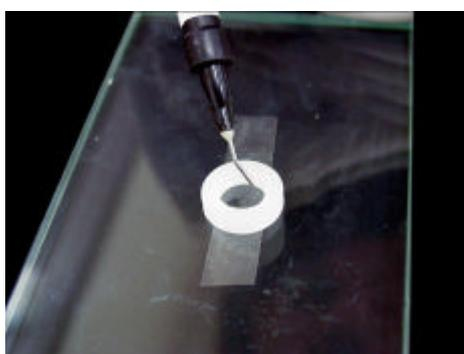
Figura 4.12 – Confeção do corpo-de-prova com resina flow
