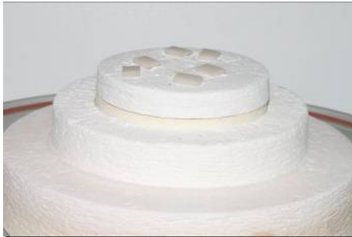
Figura 4.2 – Pastilhas de porcelana depositadas sobre lâmina de vidro e posicionadas sob a mufla do forno de porcelana
