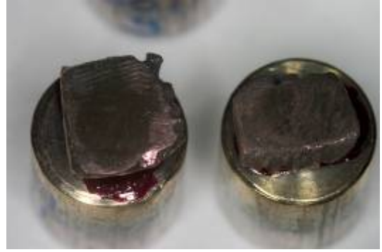
Figura 4.11 – detalhe dos corpos de prova após a metalização
