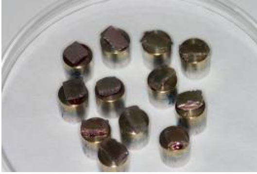
Figura 4.10 – corpos de prova colados aos “stubs” e com a camada condutora já aplicada (“sputtering”)
