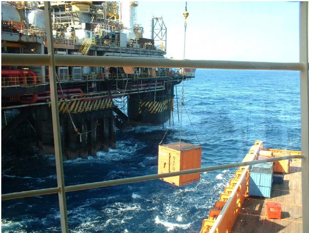
Fotografia I.2-3 –Transferência de carga entre “Supply Boat” e plataforma.
