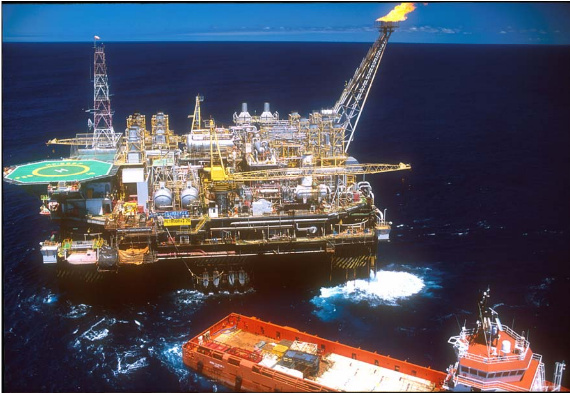
Fotografia I.2-2 – Embarcação de apoio após operação de transferência de carga, próxima a plataforma semi-submersível.
