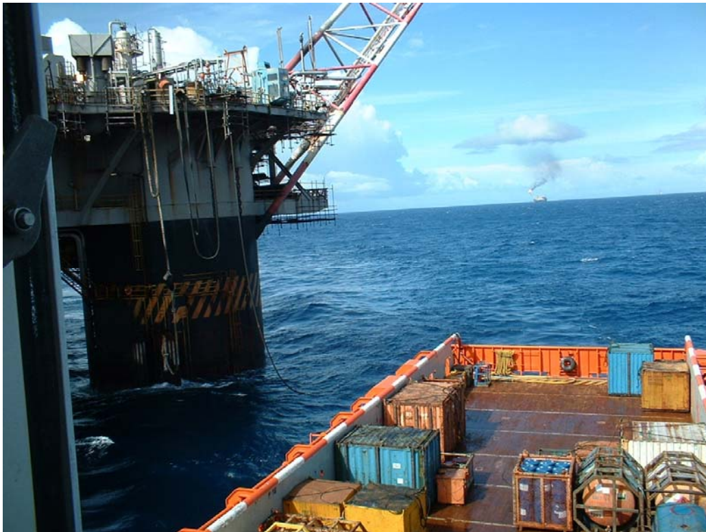
Fotografia I.2-5 – Supply Boat flutuando, em proximidade às colunas de uma plataforma, dando continuidade a operações de carga e descarga.
