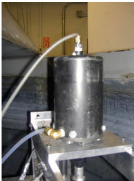
Figura 4.4 – Detalhe da junta giratória com as linhas de transmissão
