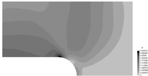
Figura A.7: Saída de deformação plástica acumulada para  $k_D = 0$ .
