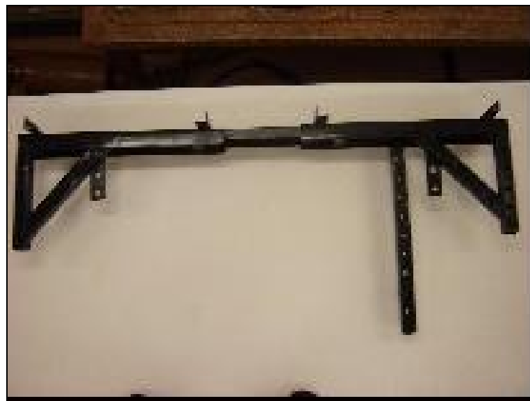
Figura 4 - Suporte de fixação do sistema automatizado, utilizado nos ensaios de campo.
