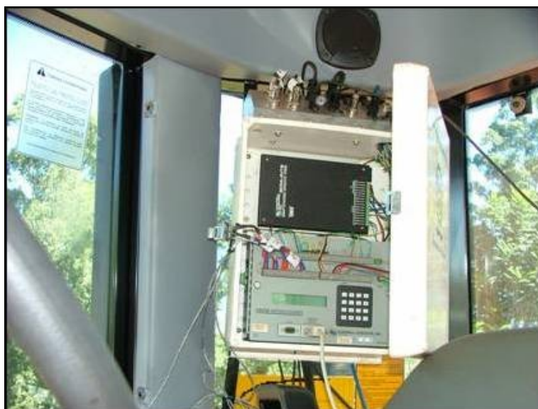
Figura 10 - Sistema de aquisição de dados montado na cabine do trator de ensaio.
