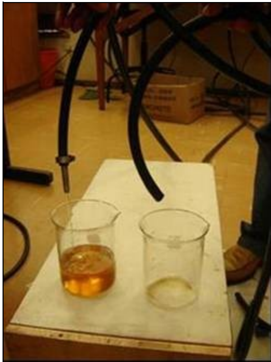
Figura 22 - Retorno do combustível do tanque 1.
