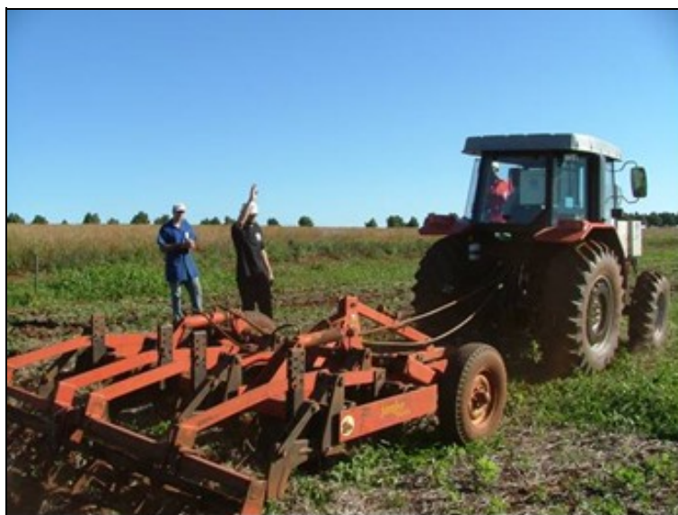
Figura 20 - Conjunto trator e escarificador utilizado nos ensaios de campo.
