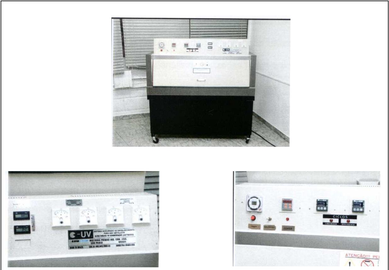
Fig. 10. Sistema Acelerado de Envelhecimento para não-metálicos C-UV (Comexim Matérias Primas, Ltda.).
