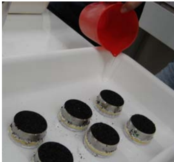
Figura 12 – Cilindros preenchidos com substrato durante o processo inicial de saturação
