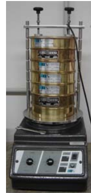
Figura 14 – Agitador mecânico utilizado na análise granulométrica
