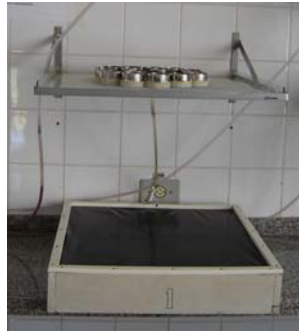
Figura 13 – Cilindros saturados alocados em mesa de tensão de 10 cm de coluna d'água
