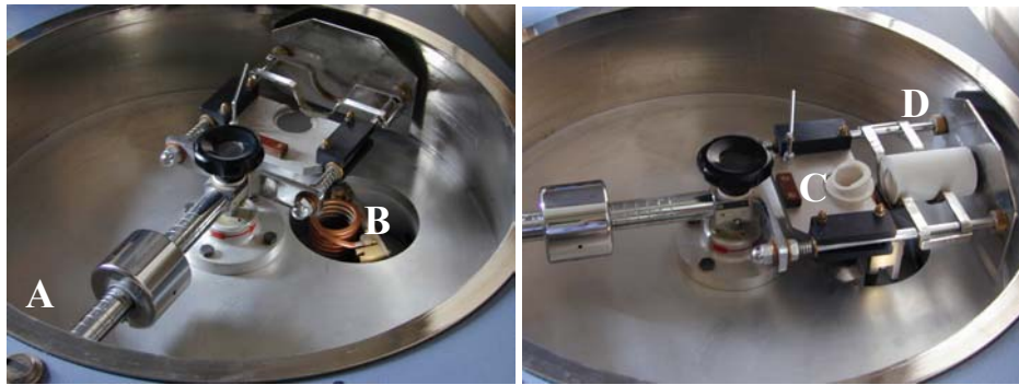
Figura 15- Câmara interna da máquina Neutrodyn Easyti®: A) centrífuga; B) bobina de indução; C) cadinho; D) molde
