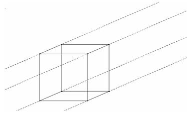
Na perspectiva cavaleira, uma das faces do objeto deve estar paralela ao plano de projeção e as paralelas são oblíquas ao plano de projeção, enquanto que na perspectiva axonométrica não é necessário que uma face seja paralela ao plano de projeção, mas as paralelas são perpendiculares ao plano de projeção.
