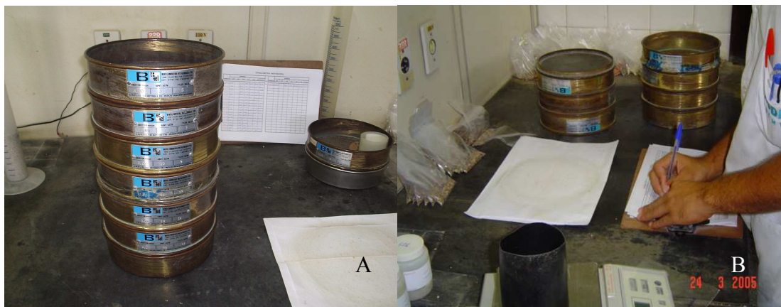
Figura 12 – Jogo de peneiras utilizadas para as análises granulométricas Foto: João Miguel Toledo Tosato, 2005.
