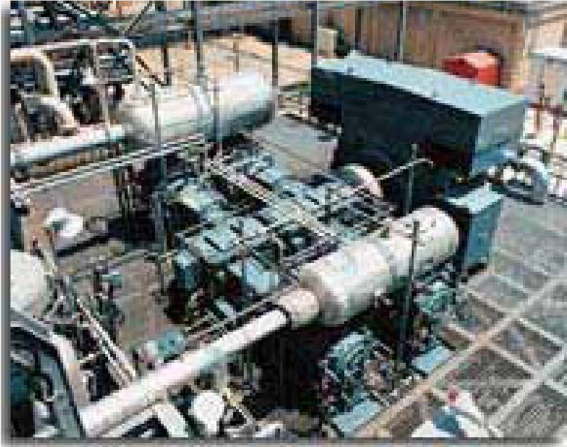
Figura 3.3 – Compressor a gás alternativo
