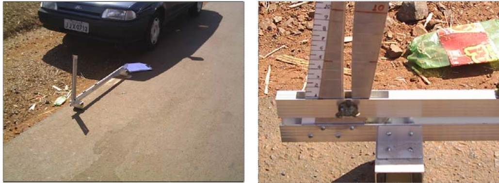
Figura 7 – Clinômetro desenvolvido na Escola de Engenharia de São Carlos
