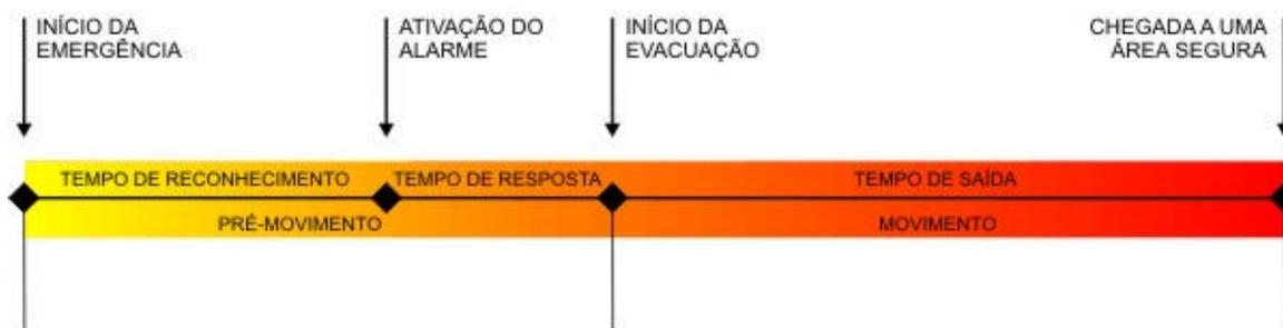
Figura 4.8 – Processo de emergência em um incêndio
