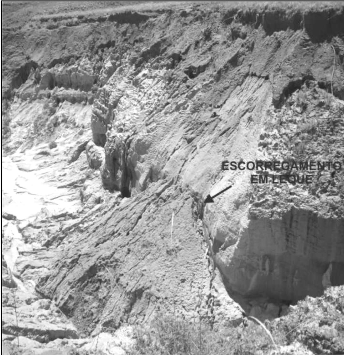
Figura 18: Escorregamento formando um leque, devido à liquefação do material. Foto: 12-12-05
