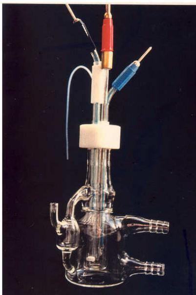
**Figura 11: Célula Eletroquímica de vidro utilizada nas medidas eletroquímicas.**
