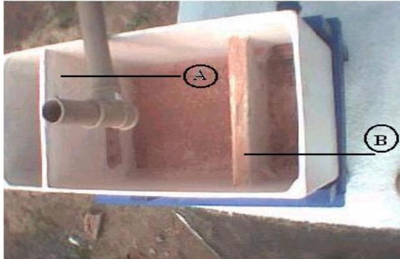
**FIGURA 11** - Visão Superior da Caixa de Nível Constante. (A) Parede Divisória com Orifícios e (B) Parede Vertedora.
