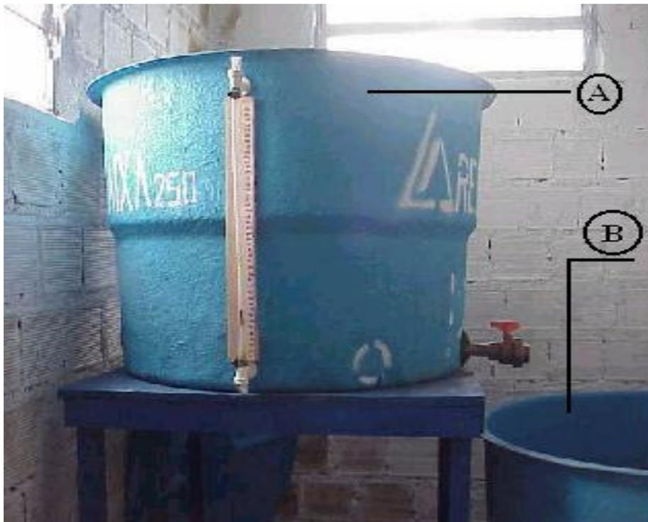
**FIGURA 03** - Tanques de Preparo da Solução Estoque. (A) Tanque T1 e (B) Tanque T2.
