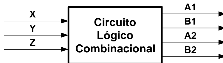
Figura 2.9 – Representação da lógica de geração dos pulsos de disparo.
