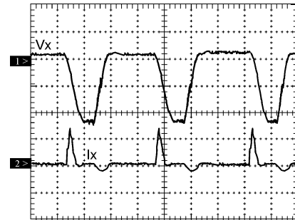
(b) Experimental Escala: Vx (50V/div.); Ix (1A/div.); tempo (2 \mu s/div.)
