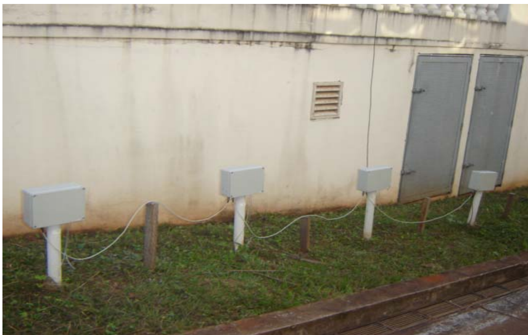
Figura 4.5 – Foto das quatro sondas analíticas utilizadas para determinação de \text{NH}_4^+ e \text{NO}_3^- .
