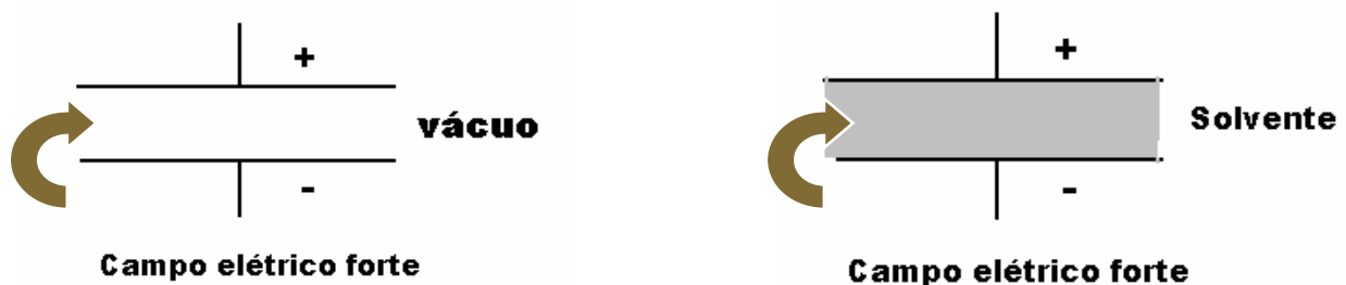
FIGURA 3.2 - Representação de um capacitor para medição da \epsilon_r . 12
