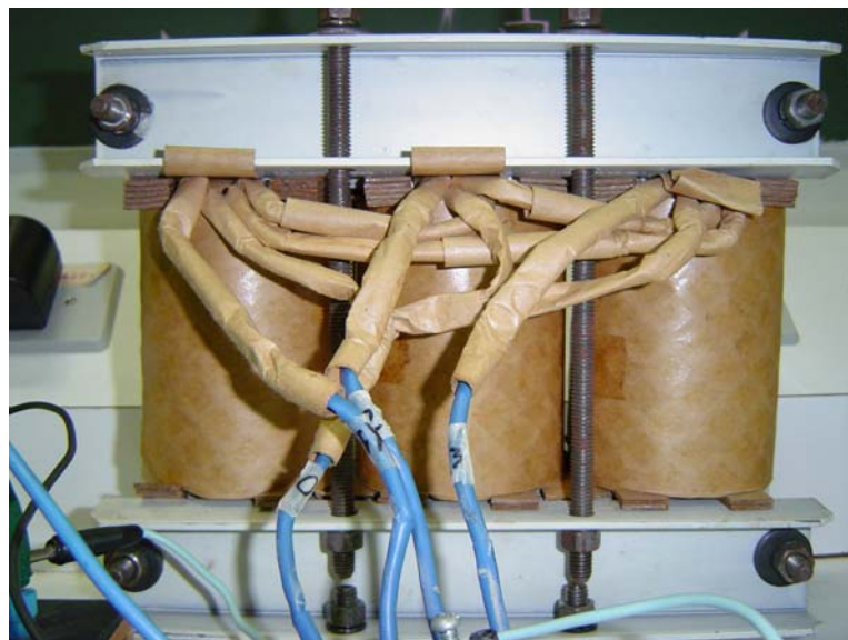
Figura 4.1 - Protótipo do filtro eletromagnético de seqüência zero
