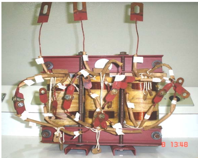
Figura 4.15 - Protótipo do filtro eletromagnético de seqüência positiva e negativa
