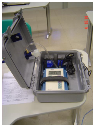
Figura 3 – Detalhe do monitor e da bateria de chumbo posicionada na parte superior do gabinete.
