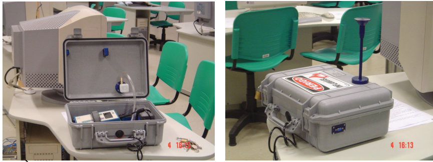
Figura 2 – À esquerda, vista do gabinete aberto com o monitor de aerodispersóides e à direita, vista do gabinete fechado, com a haste de entrada do amostrador.
