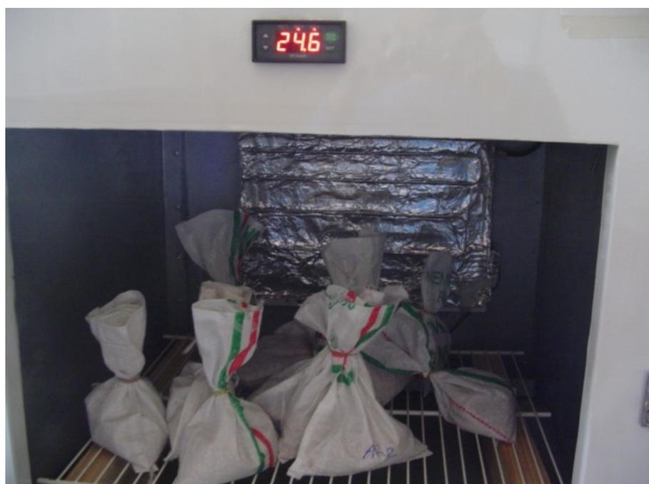
**Figura 2.15** -Fotografia dos saquinhos de polietileno com sementes de soja no interior da mini-câmara.
