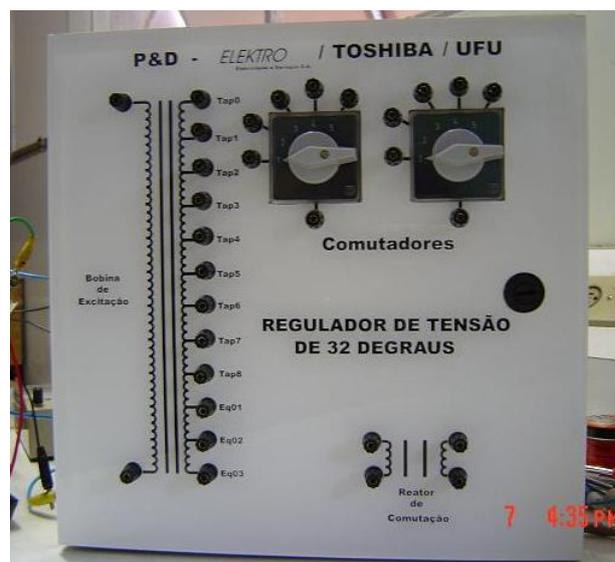
*Figura 4.1: Foto mostrando a vista frontal do regulador de tensão construído.*
