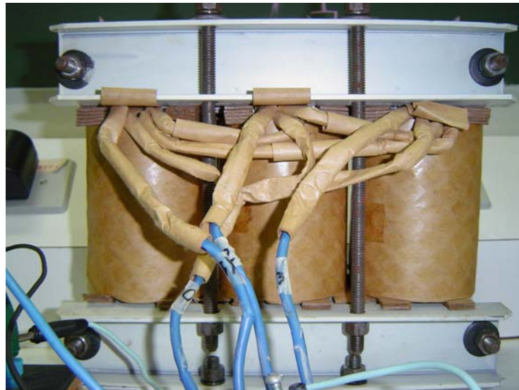
Figura 3.6 – protótipo do filtro eletromagnético.
