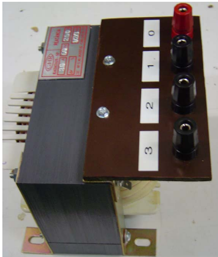
Figura 4.1 – Reator com taps para 1, 2 e 3mH.
