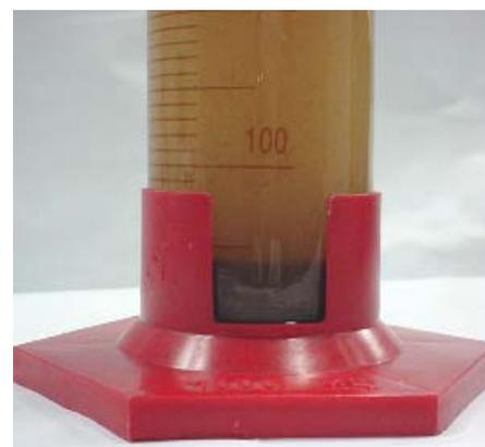
Figura 6. Destaque dos lodos ativados decantados
