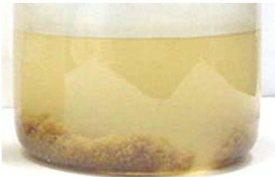
Figura 9. Efluente Coagulado com  $\text{FeCl}_3$  e polieletrólito catiônico
