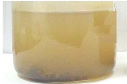
Figura 10. Efluente coagulado com  $\text{FeCl}_3$  polieletrólito aniônico
