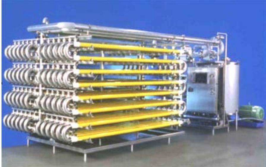
Figura 16. Foto de arranjo de módulos com membranas (Koch,2004)
