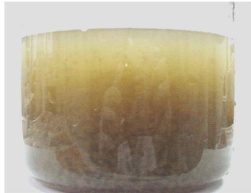
Figura 8. Efluente Coagulado com  $\text{FeCl}_3$
