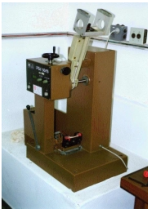
FIGURA 11 - Máquina de Impacto PSd 15/50 utilizada no ensaio de impacto.
