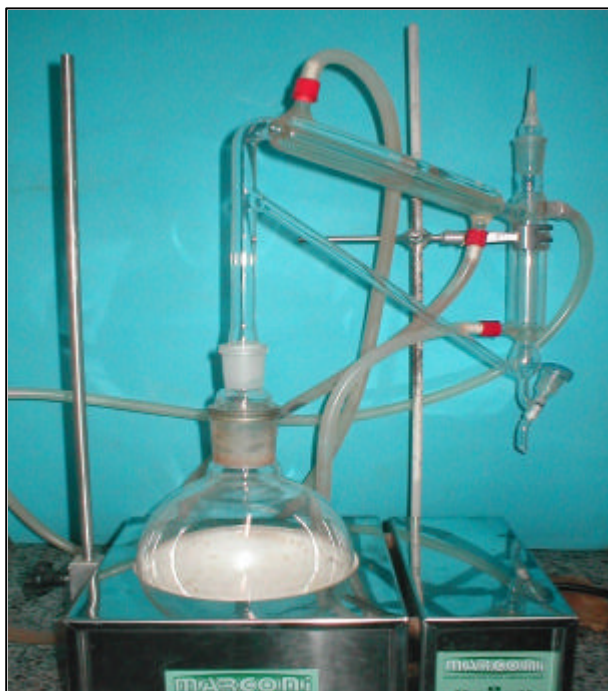
Figura 4. Equipamento hidrodestilador tipo Clevenger.
