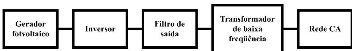
Figura 1.8: SFCR utilizando transformador de baixa frequência.
