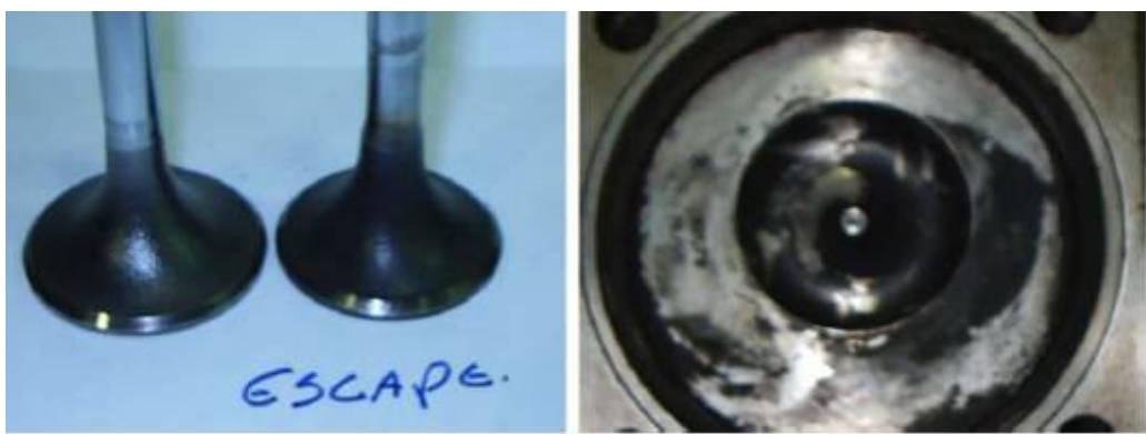
Figura 14 - Fotos de um par de válvulas e de um cilindro após a limpeza
