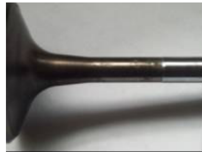
Figura 03 - Corrosão por “pit” numa das válvulas de admissão, observada após a remoção do depósito
