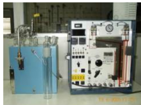
Figura 52 - Instrumentação utilizada na determinação do teor de alcatrão e material particulado presentes nos gases
