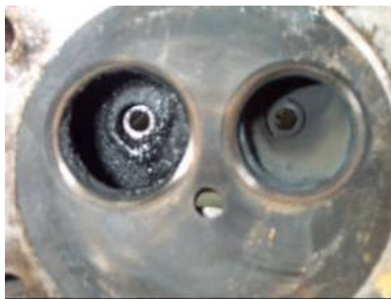
\Figura 01 - Deposição de alcatrão na sede da válvula de admissão de um cilindro Fonte: USHIMA, 2004f.
