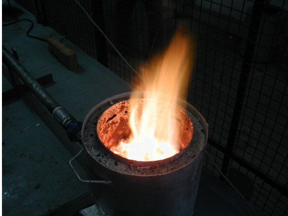
Figura 9. Gaseificador - fogão em funcionamento
