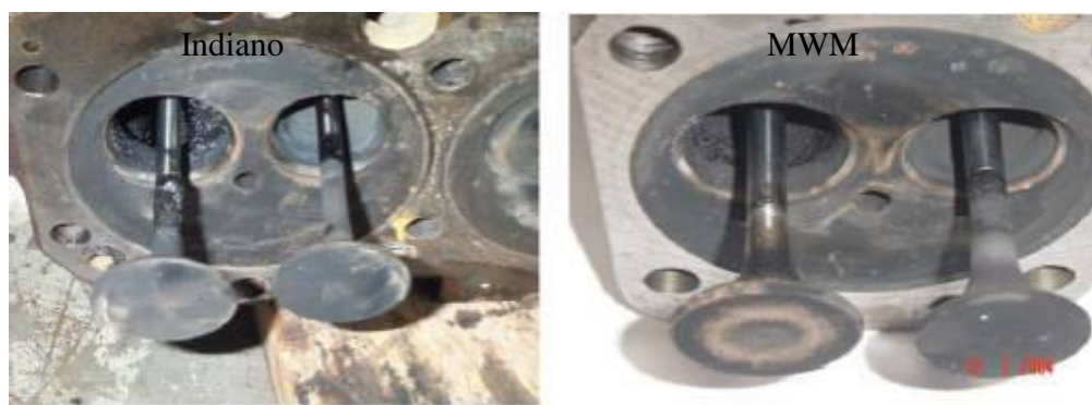
Figura 13 - Comparação do estado das válvulas de um dos cilindros dos motores indiano e MWM, após 100 horas de operação no modo dual
