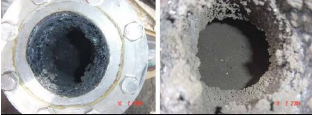
Figura 68 - Depósitos formados na entrada e saída do dispositivo de coleta inercial, instalado após o trocador de calor
