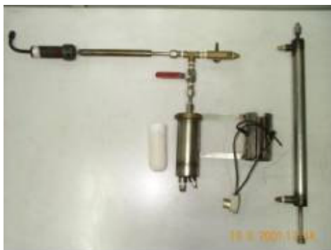
Figura 52 - Instrumentação utilizada na determinação do teor de alcatrão e material particulado presentes nos gases
