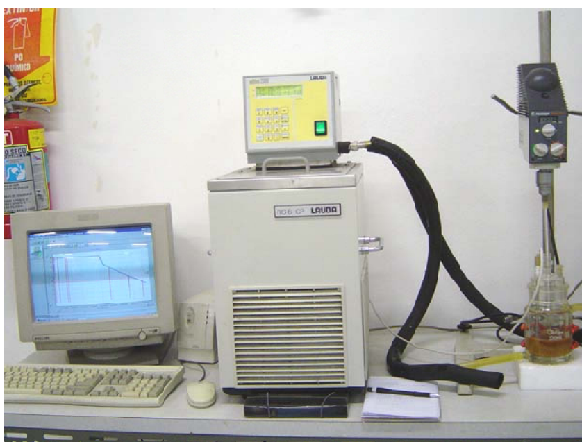
Figura 8 Cristalizador de 300 mL de capacidade total.
