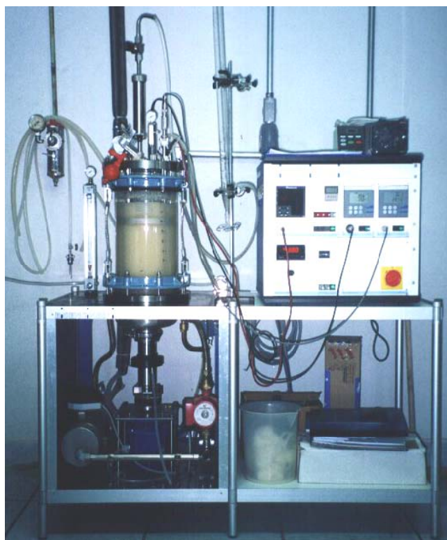
Figura 7 Fermentador de 16 L de capacidade total.
