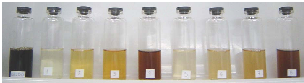
Figura 20 Ensaios de clarificação do caldo fermentado com resinas de troca iônica. Da esquerda para direita: caldo e ensaios de 01 a 08.
