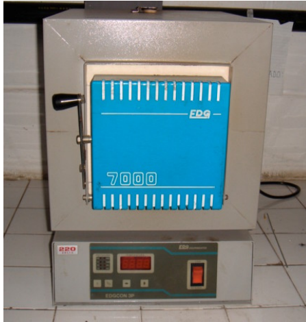
Figura 5.1 Forno utilizado para realização do tratamento térmico
