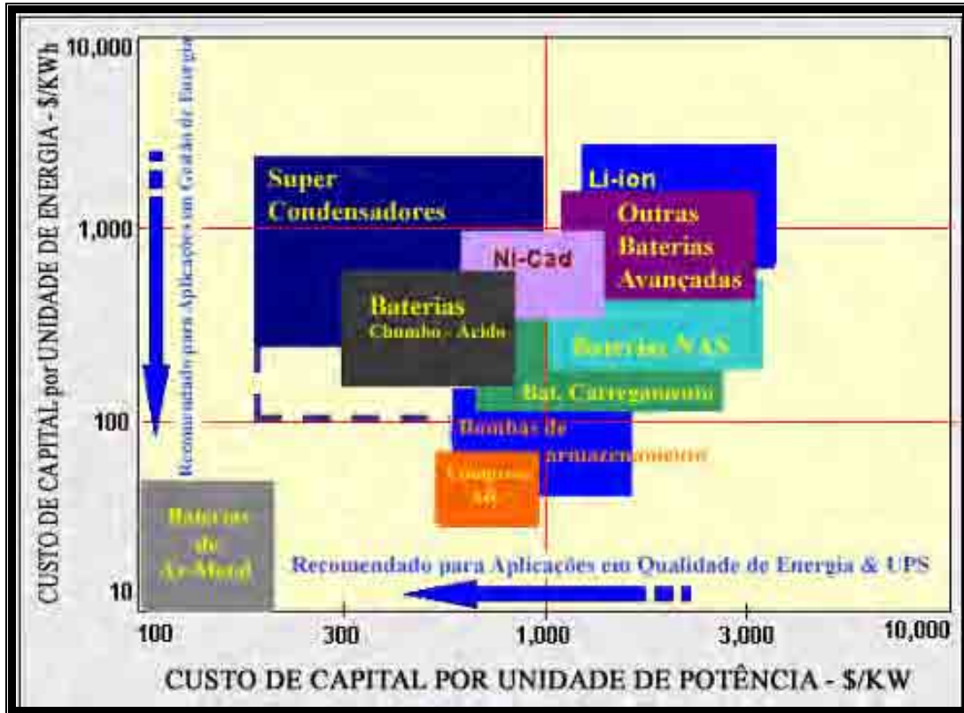
Fig. 2.10: Gráfico Custo por unidade de energia x Custo por unidade de potência
